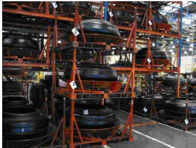
Obr. 21 Surové pláště uložené ve skladu
