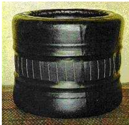
Obr. 19 Radiální plášť - 1. stupeň
