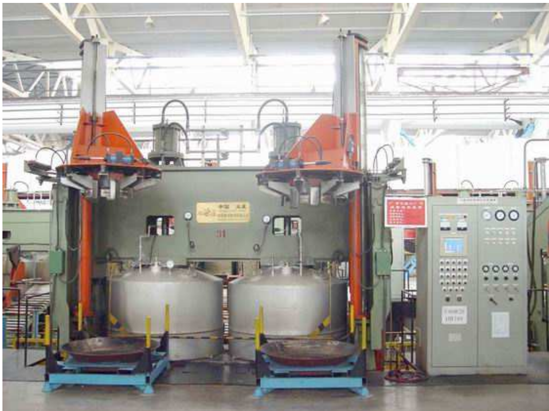
Obr. 3 Membránový vulkanizační lis
