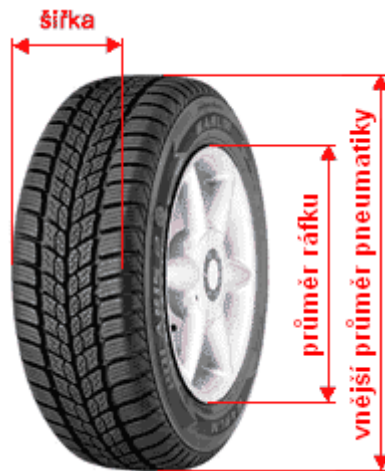
Obr. 10 Hlavní rozměry pneumatiky
