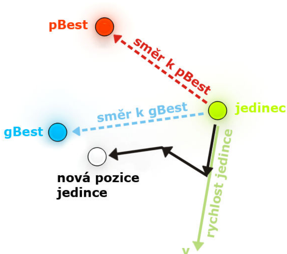
Obrázek 5. Pohyb jedince ovlivněný pBest a gBest jedinci
