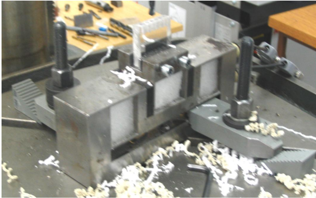
Obr. 48. Dynamometr na měření pasivní složky při vrtání
