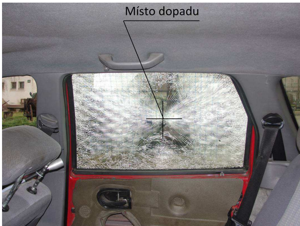
Obr. 83. Vnitřní pohled na autosklo s bezpečnostní autofólií
