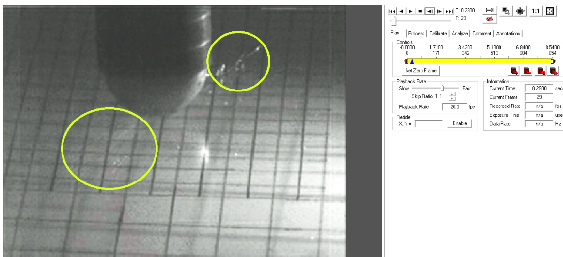
Obr. 62. Zachycení prvního náznaku šíření lomů (snímek 29)
