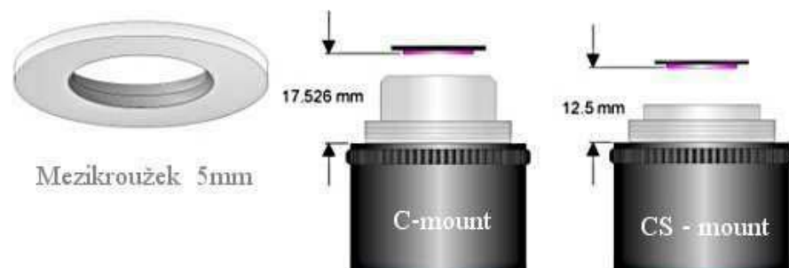
Obr. 14: Způsoby uchycení objektivů [9]
