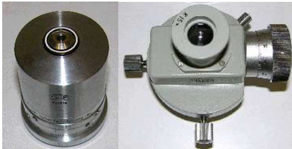
Obr. 13. Nástavec a merací okulár mikrotvrdomeru Hanneman
