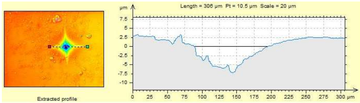
Obr. 39. Vyhodnotenie odlačky v mieste rezu
