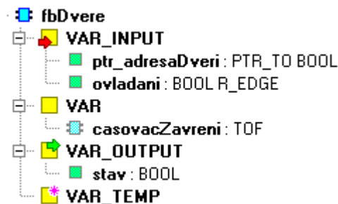
Obr. 31 Funkční blok dveří – vstupy
