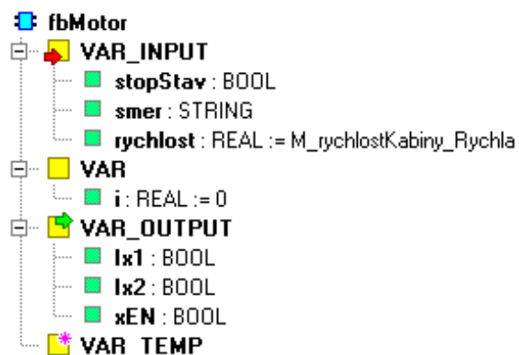
Obr. 33 Funkční blok motoru – vstupy
