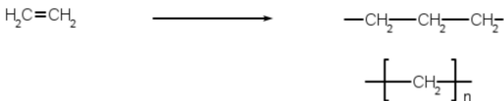
Obrázek 27: Polymerace ethylenu za vzniku řetězců polyethylenu [55].
