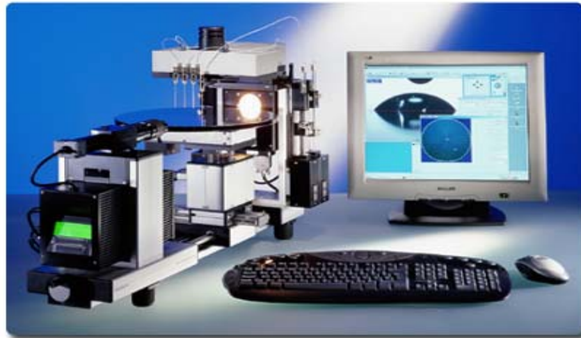
Obrázek 14: OCA 20 DataPhysics s PC příslušenstvím pro měření kontaktního úhlu smáčení [30].
