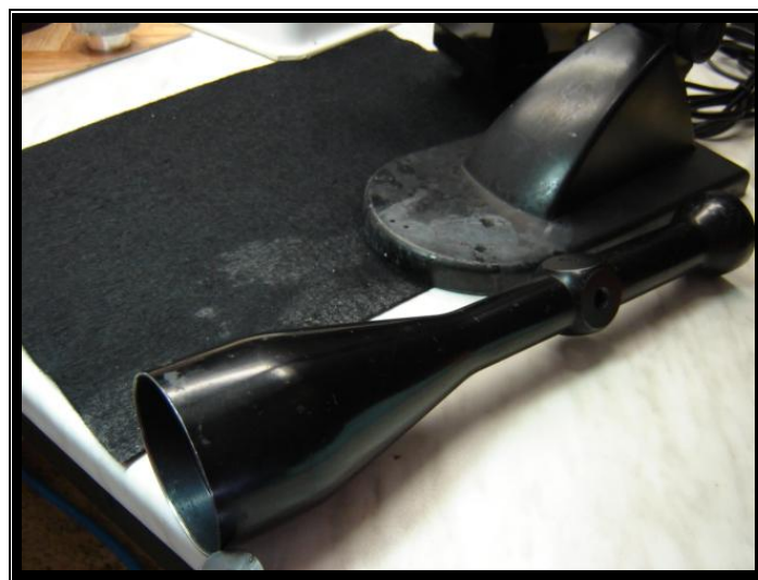
Obr. 34 Tubus pro kontrolu podsestavy. Zdroj: [Vlastní zpracování].
