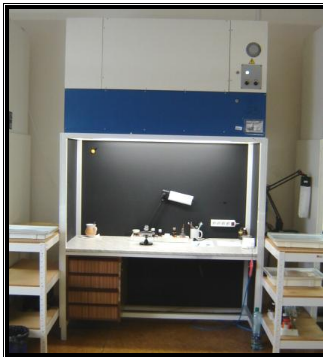
Obr. 14 Flow-box. Zdroj: [Vlastní zpracování].
