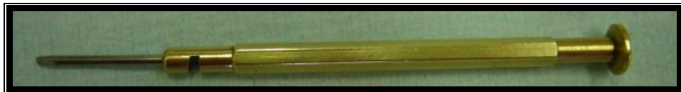
Obr. 35 Šroubovák používaný při justáži. Zdroj: [Vlastní zpracování].
