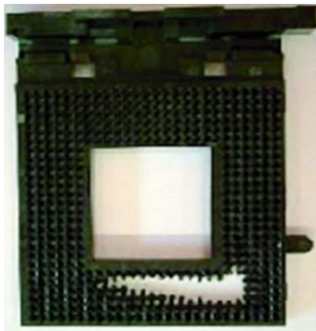
Obr. 24 Predikce uzavírání vzduchu – reálný výlisek [8]
