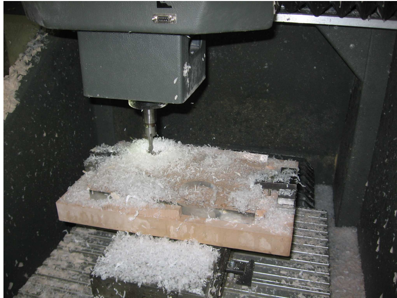
Obr. 54 Frézování kruhových otvorů v upínací desce
