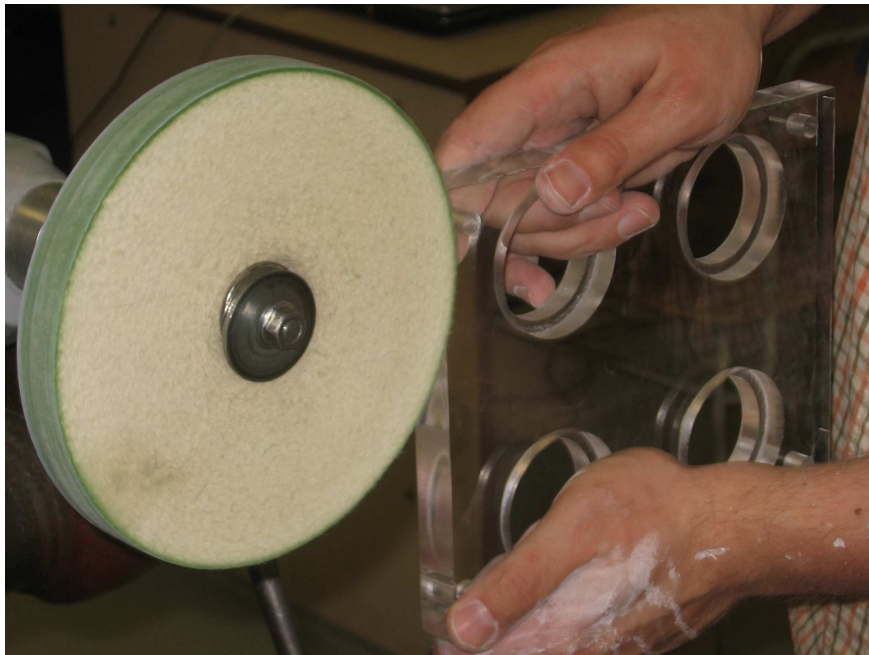
Obr. 58 Leštění hrany desky filcovým kotoučem
