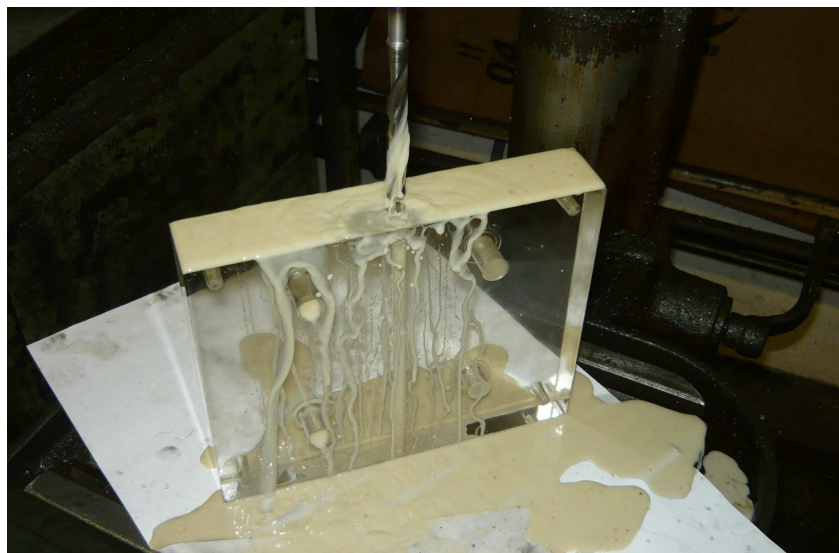
Obr. 51 Převrtání kanálku o \varnothing 8 mm na \varnothing 10 mm
