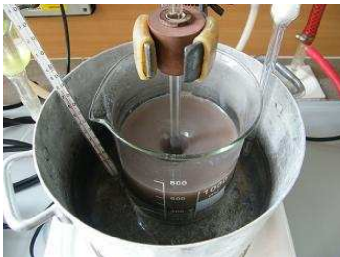
Obr. č. 11: Zahřívání vodného roztoku CLOISITE ® Na + a AgNO 3
