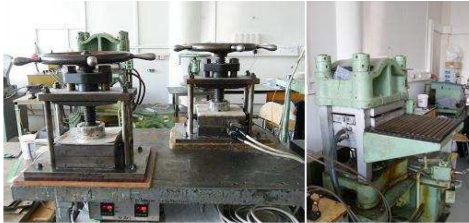
Obr. č. 13: Zleva: ruční vyhřívané lisy, hydraulický chladící lis
