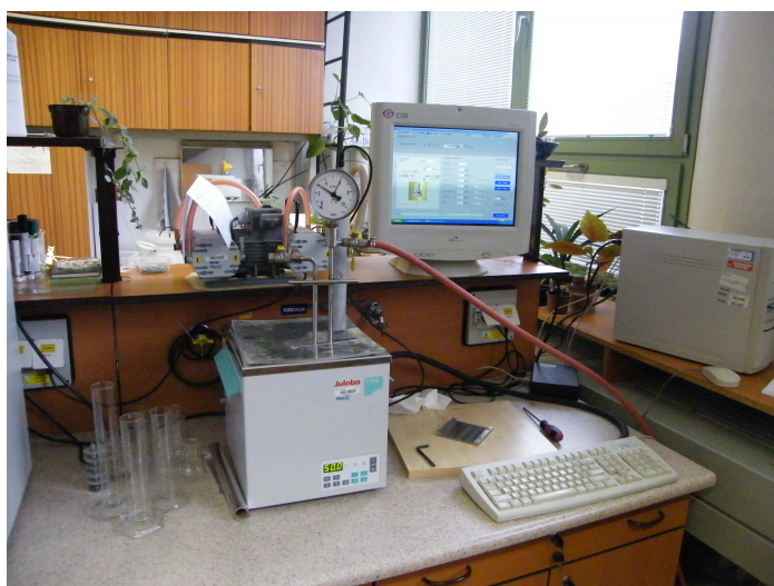
Obr. č. 16: Zařízení používané k hodnocení plynopropustnosti
