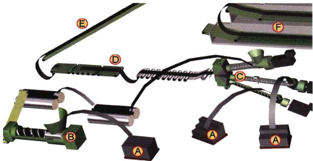
Obr. 6. Linka pro vytlačování sdužených profilů (A- palety směsí, B- extruder, C- sdužený extruder, D- odtahový dopravník s úsekovou váhou a značením, E- šikmý dopravník, F- etážová chladička s vodou [3])
