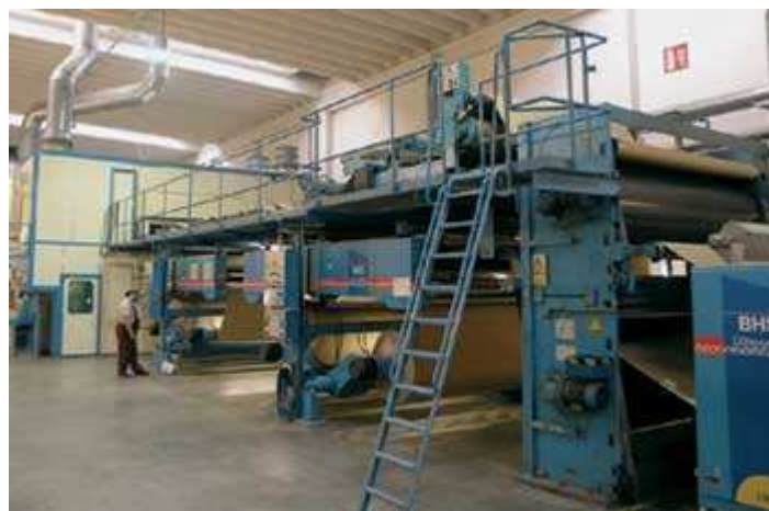
Obr.č. 9. Část výrobní linky na výrobu vlnité lepenky
