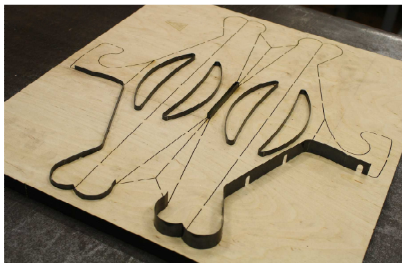
Obr.č. 15. Ukázka vsazování sekacích nožů
