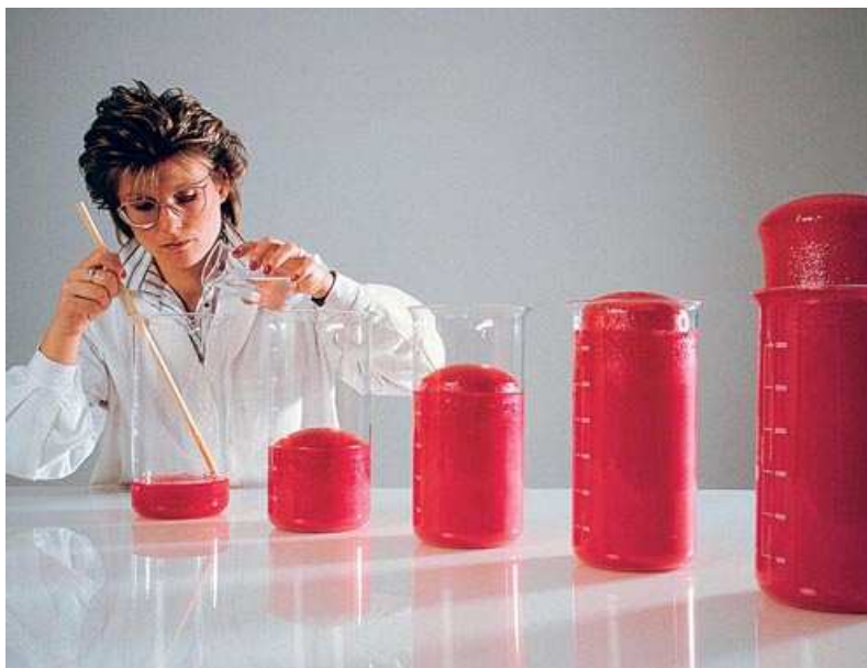
Obr. 9: Po smíchání dvou tekutých složek – polyolu a izokyanátu - dojde k výraznému napěnění [3]
