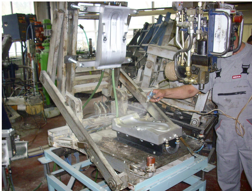
Obr. 41: Stříkání separátoru na stěny formy
