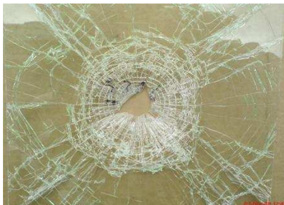
Obr. 7. Typicky deformované VBS při projití předmětu skrz [2]
