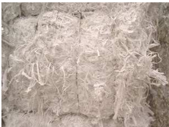
Obr. 11. Rekuperovaná PVB fólie z automobilních skel [2]
