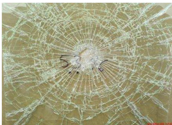
Obr. 6. Typicky deformované VBS při zadržení předmětu [2]
