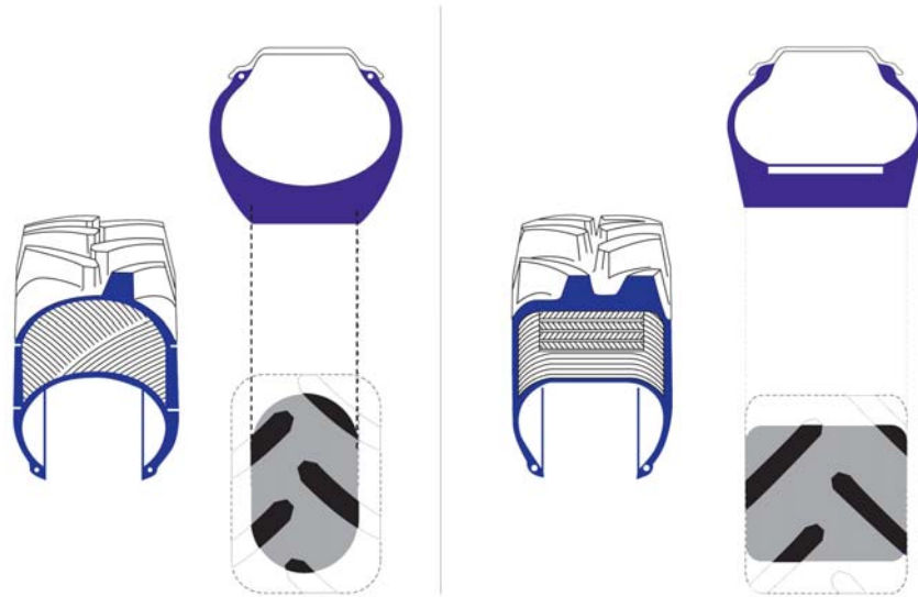
Obr. 25. Konstrukce diagonální a radiální pneumatiky
