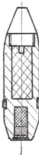
Obrázek 8. Tříštivo-trhavá střela (granát) svítící [4]
