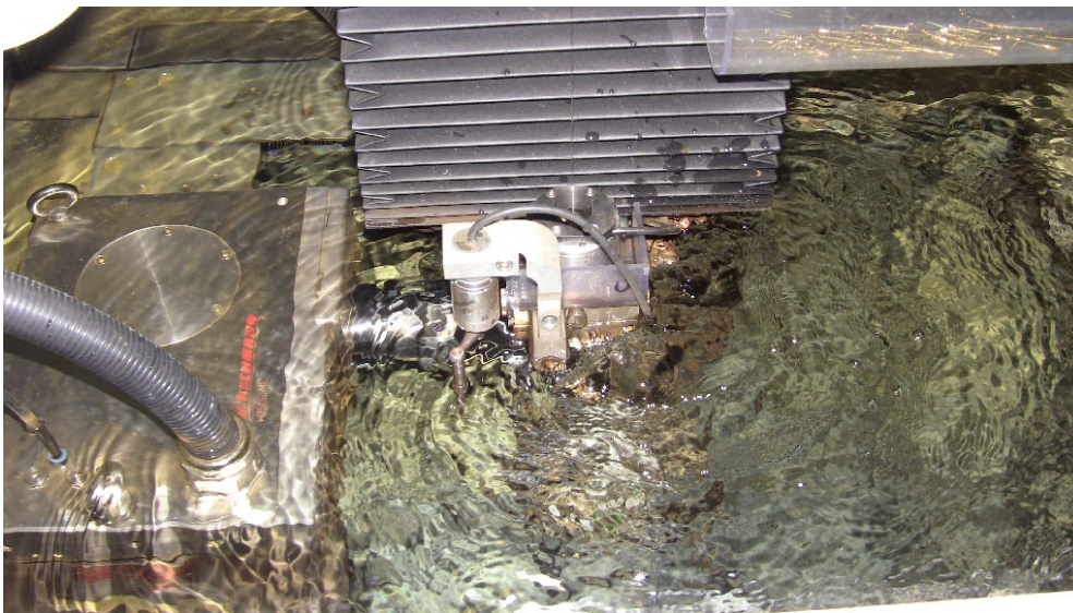
Obr. 58 Pracovní kád' drátové řezačky FANUC ROBOCUT \alpha -1iD
