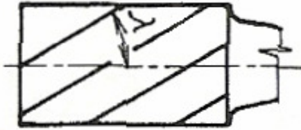
Obr. 10 Úhel sklonu zubu [2]
