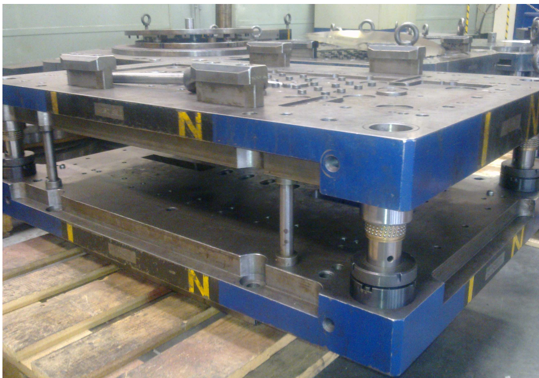
Obr. 26. Univerzální vodící desky pro blokové nástroje na segmenty
