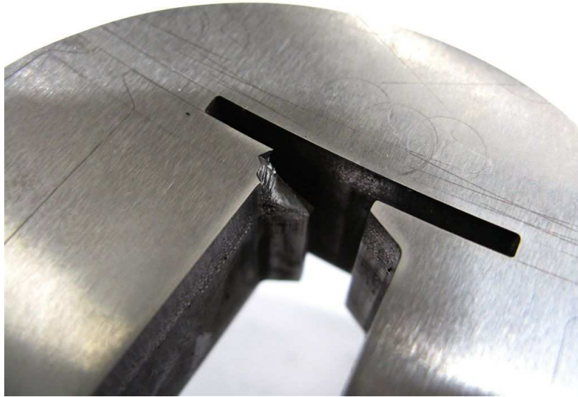
Obr. 32. Typická závada-vylomená střižná hrana drážkového střižného nástroje
