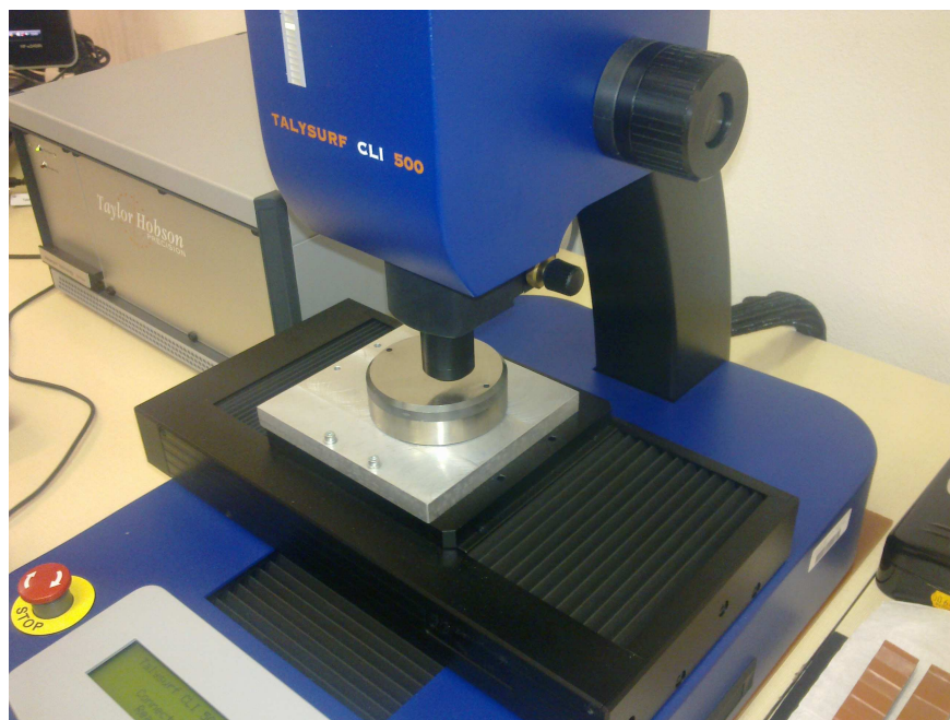
Obr. 45. Měření drsnosti na přístroji Talysurf CLI 500
