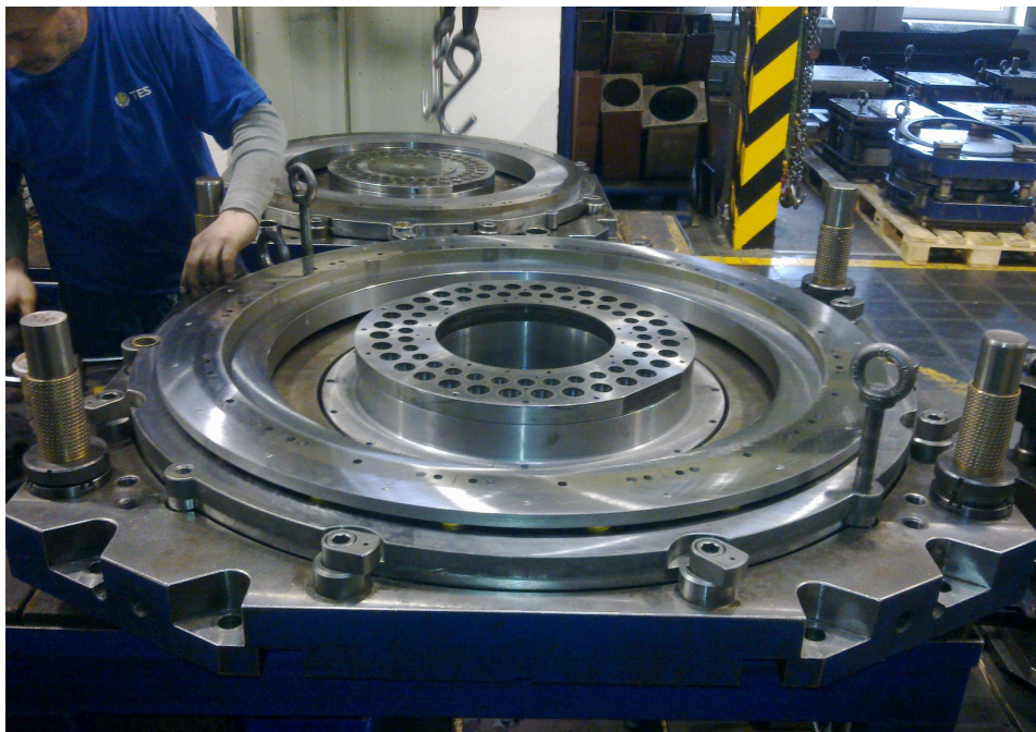
Obr. 31. Příprava blokového střížného nástroje – upínání do univerzálních vodících desek
