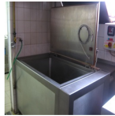
Obr.č.24 Varný kotel
