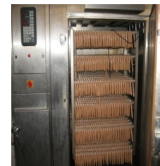
Obr.č.28 Udírna s udírenským vozem
