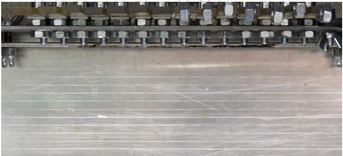
Obr. 95 Zobrazení zkušebních těles PA11 v různých dávkách ozáření v čase 45min. o teplotě 100°C
