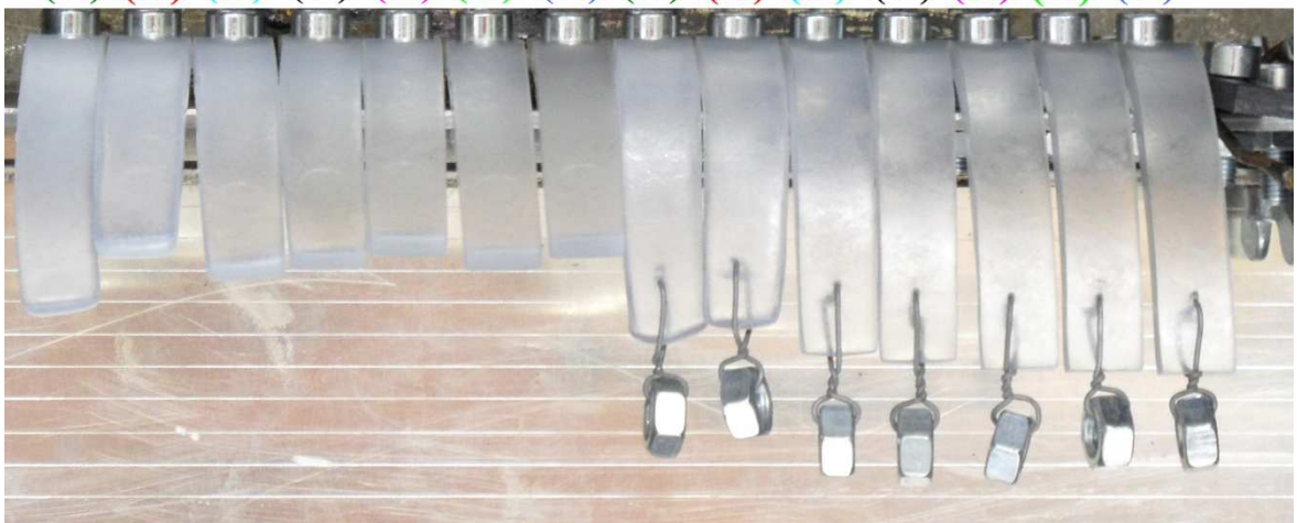
Obr. 56 Zobrazení zkušebních těles LDPE v různých dávkách ozáření v čase 65min. o teplotě 100°C
