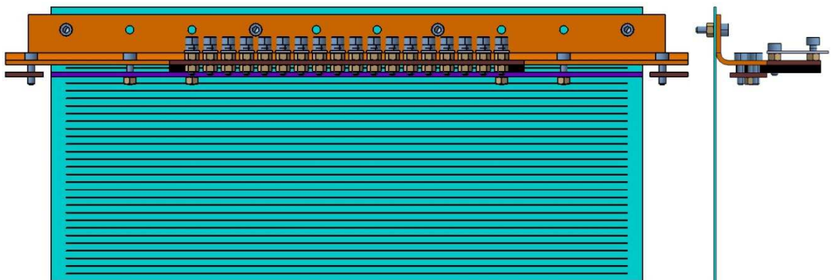
Obr. 52 3D model přípravku do horkovzdušné trouby MORA 4807
