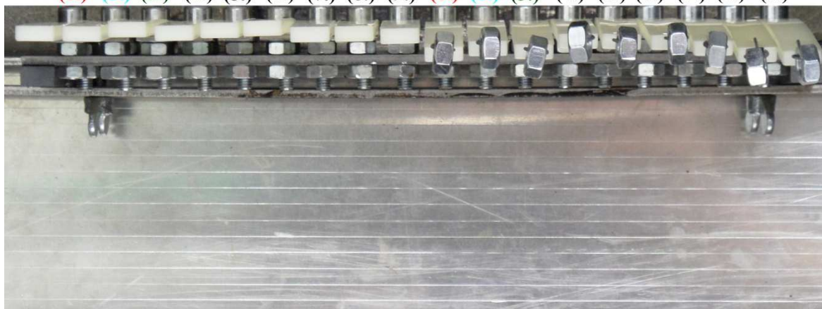
Obr. 69 Zobrazení zkušebních těles PP v různých dávkách ozáření v čase 85min. o teplotě 150°C
