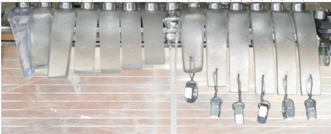
Obr. 57 Zobrazení zkušebních těles LDPE v různých dávkách ozáření v čase 90min. o teplotě 120°C
