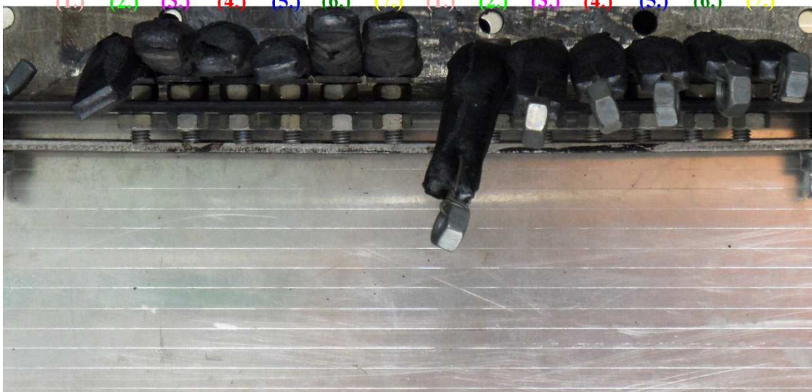
Obr. 112 Zobrazení zkušebních těles PA9T v různých dávkách ozáření v čase 120min. o teplotě 350°C
