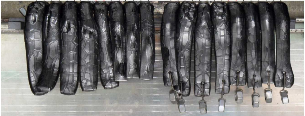
Obr. 127 Zobrazení zkušebních tělísek PA6.6 v různých dávkách ozáření v čase 120min. o teplotě 350°C
