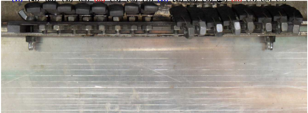
Obr. 132 Zobrazení zkušebních těles PA6.6 30%GF v různých dávkách ozáření v čase 120min. o teplotě 350°C
