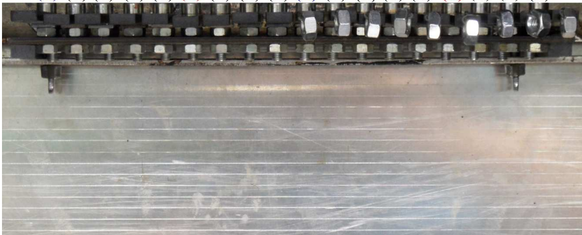
Obr. 119 Zobrazení zkušebních těles PA6 30%GF v různých dávkách ozáření v čase 30min. o teplotě 220°C
