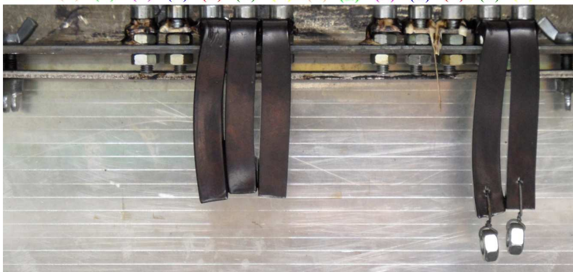
Obr. 84 Zobrazení zkušebních těles PBT v různých dávkách ozáření v čase 120min. o teplotě 300°C
