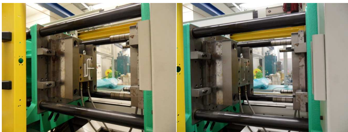
Obr. 45 Pohled do prostoru vstřikovacího stroje před a po vyhození vzorku
