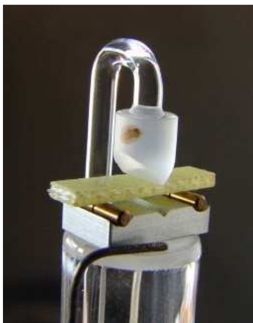
Obr. 24 Detail uspořádání sonda-vzorek při měření tříbodového ohybu [20]
