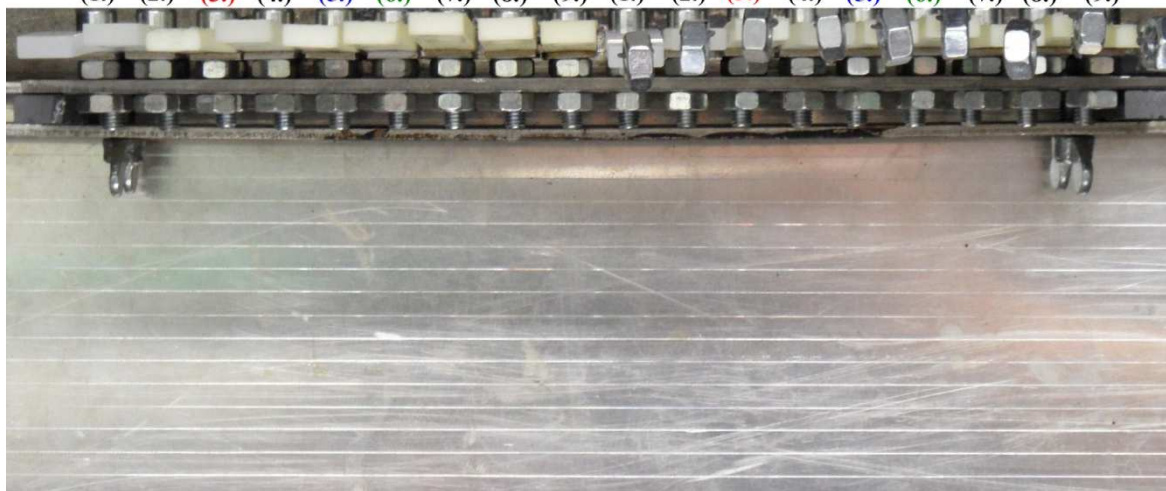
Obr. 75 Zobrazení zkušebních těles PP 25%GF v různých dávkách ozáření v čase 85min. o teplotě 150°C
