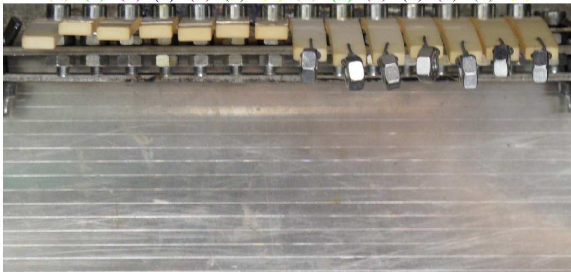
Obr. 82 Zobrazení zkušebních těles PBT v různých dávkách ozáření v čase 60min. o teplotě 220°C
