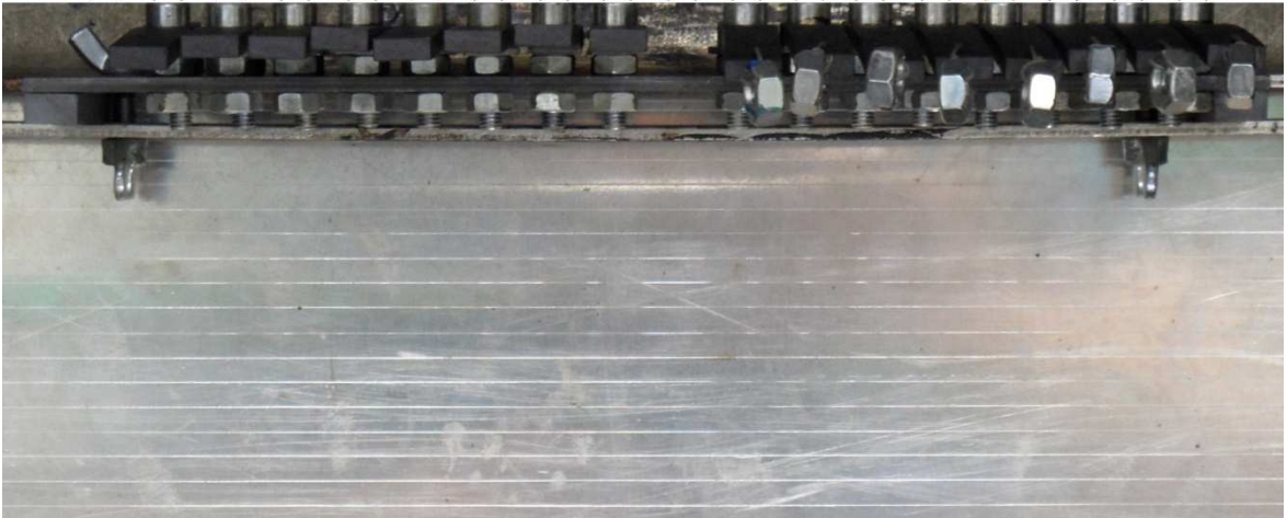
Obr. 121 Zobrazení zkušebních tělísek PA6 30%GF v různých dávkách ozáření v čase 90min. o teplotě 300°C
