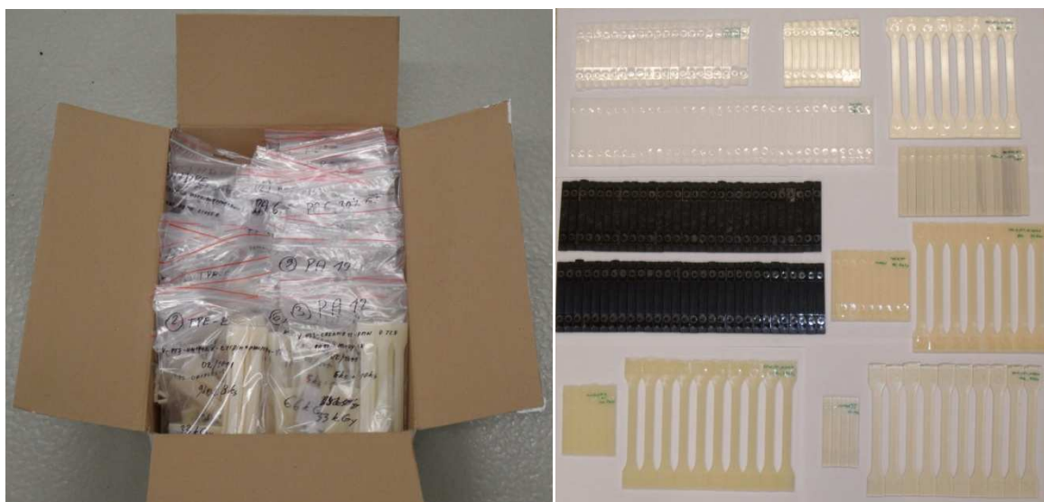
Obr. 46 Roztržené zkušební tělesa před radiačním sítováním
