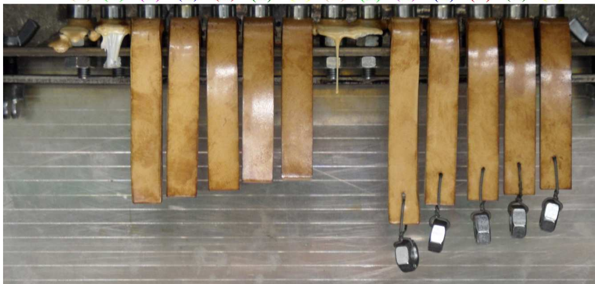
Obr. 83 Zobrazení zkušebních těles PBT v různých dávkách ozáření v čase 90min. o teplotě 250°C
