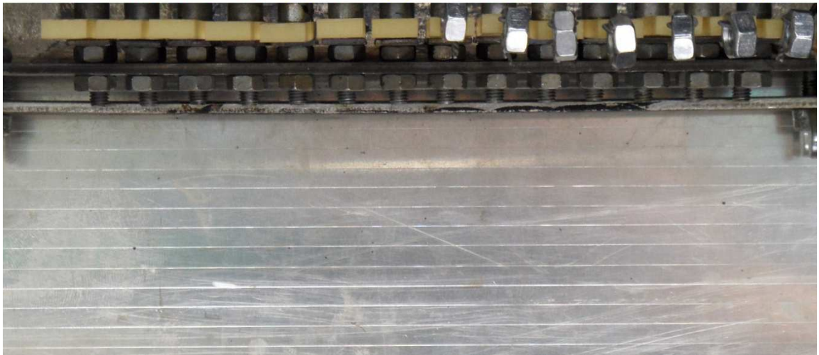
Obr. 109 Zobrazení zkušebních těles PA9T v různých dávkách ozáření v čase 30min. o teplotě 220°C
