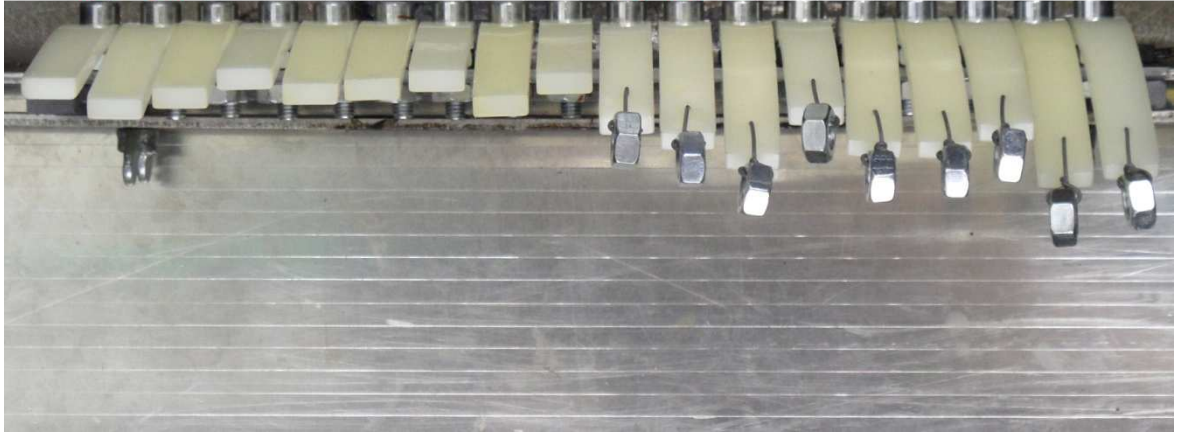
Obr. 70 Zobrazení zkušebních těles PP v různých dávkách ozáření v čase 100min. o teplotě 160°C
