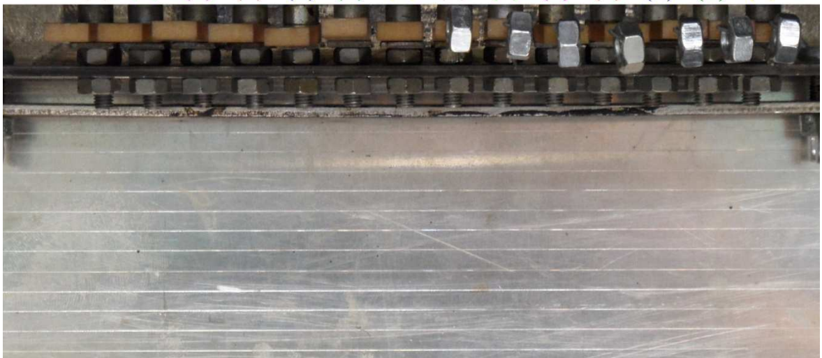
Obr. 110 Zobrazení zkušebních těles PA9T v různých dávkách ozáření v čase 60min. o teplotě 250°C
