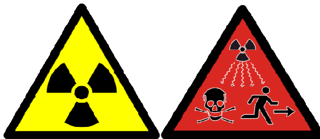
Obr. 10 Mezinárodní výstražný symbol, označující zdroj ionizujícího záření a nový doplňkový výstražný symbol ionizujícího záření [11]
