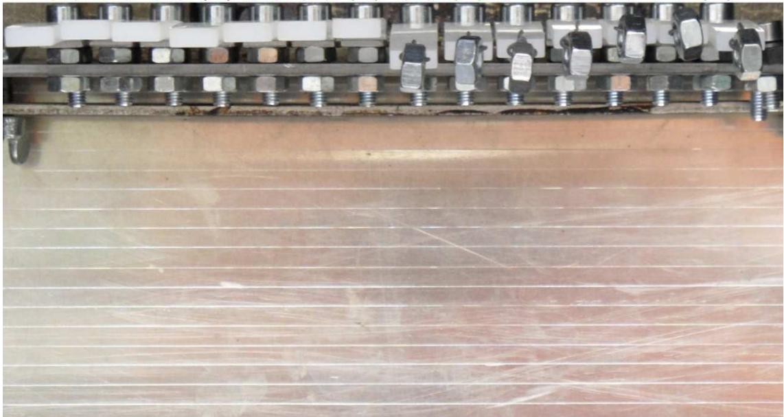
Obr. 62 Zobrazení zkušebních těles HDPE v různých dávkách ozáření v čase 90min. o teplotě 120°C
