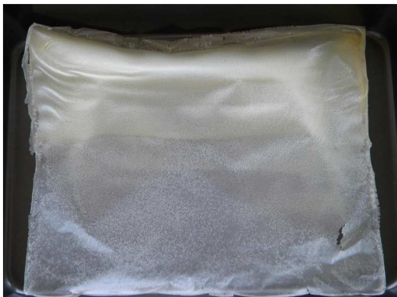
Obr. 8. Film želatiny (hydrolyzátu) po vysušení (40 °C, 48 h)
