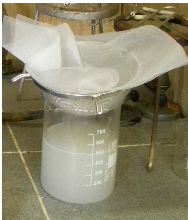
Obr. 6. Filtrace roztoku želatiny (hydrolyzátu) po 3. stupni extrakce
