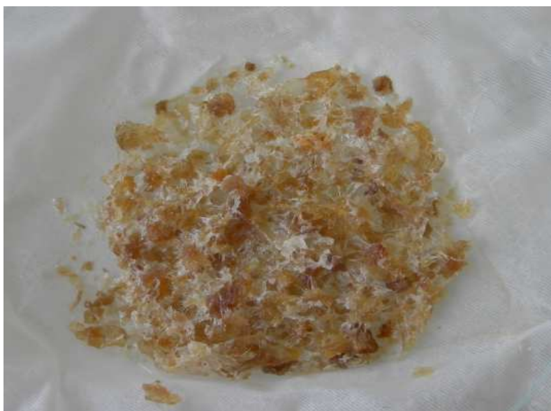
Obr. 9. Nerozložený podíl po vysušení (103 °C, 20 h)
