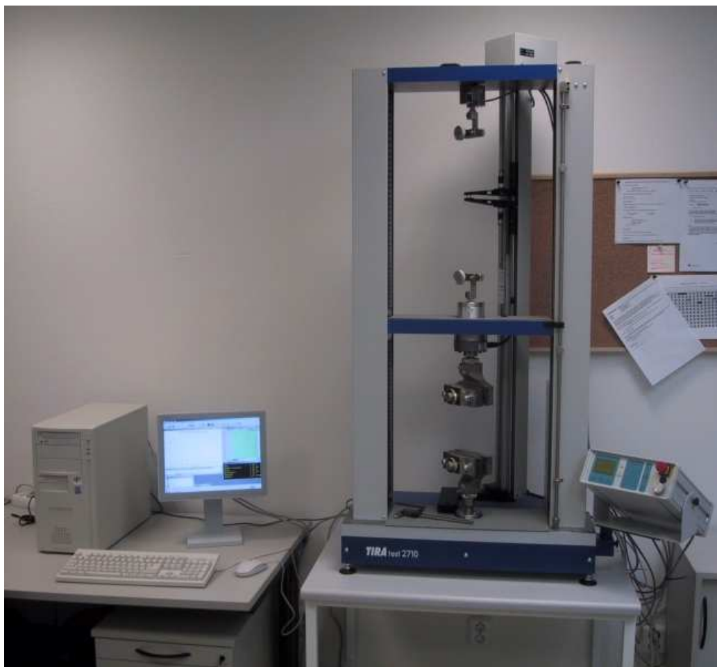
Obr. 13. Trhací stroj TIRA Test 2710 (SPUR a.s.)
