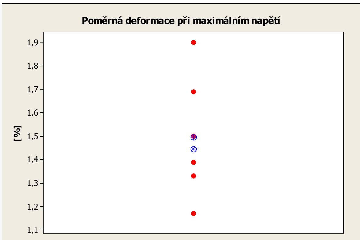
Obr. 46. Vyhodnocení poměrné deformace vzorek zúžený na 6mm optimalizovaný
