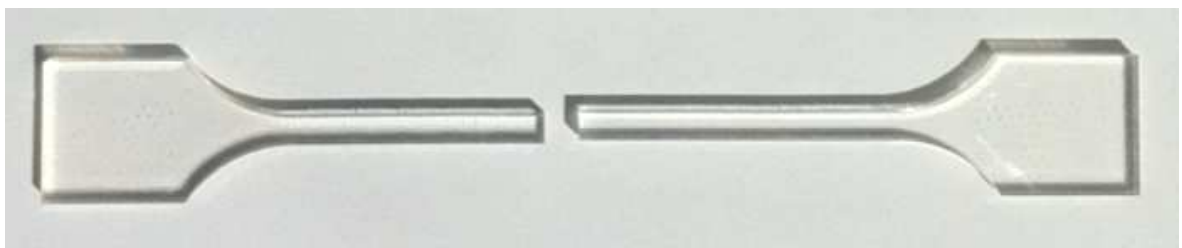
Obr. 35. Přetržení vzorku typ 1A zúžený na 4mm
