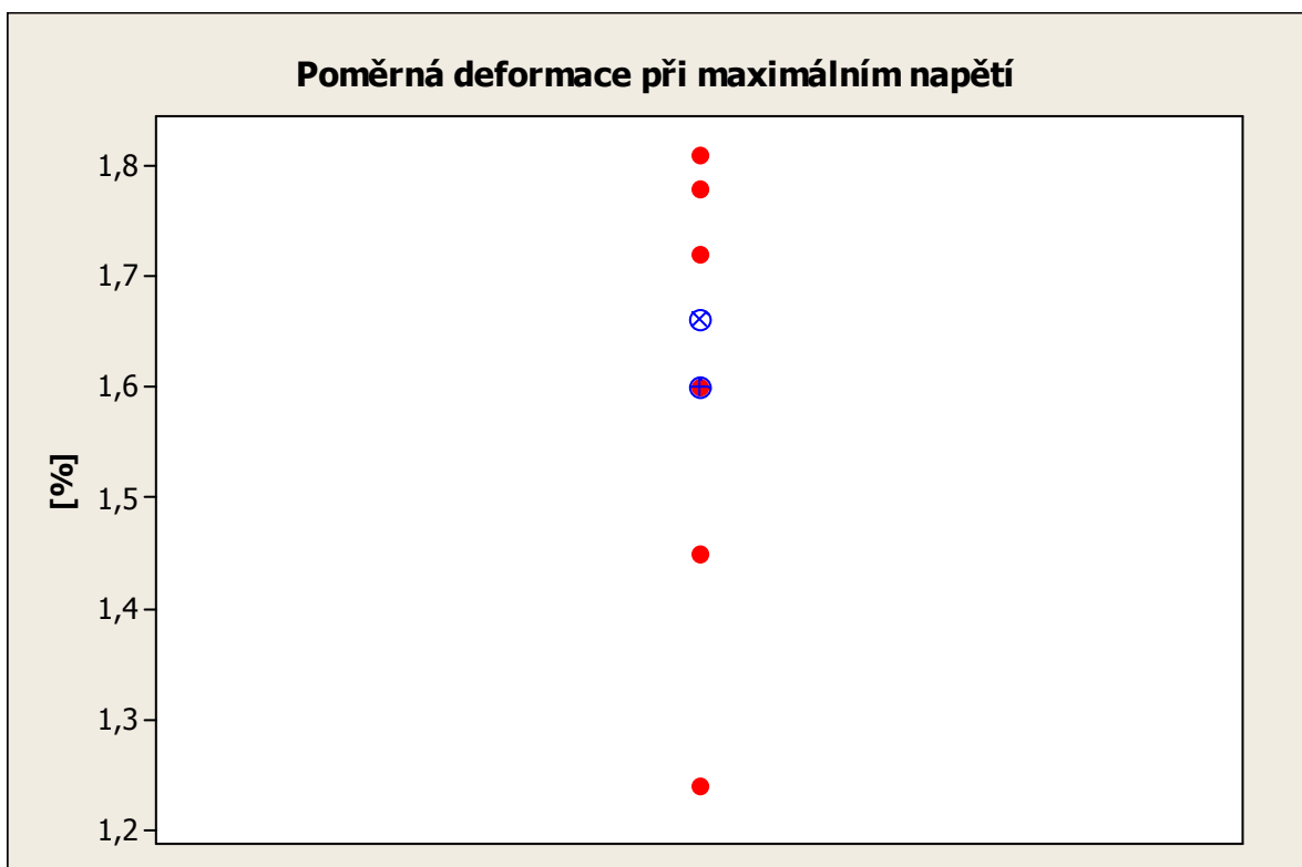
Obr. 49. Vyhodnocení poměrné deformace vzorek zúžený na 4mm optimalizovaný
