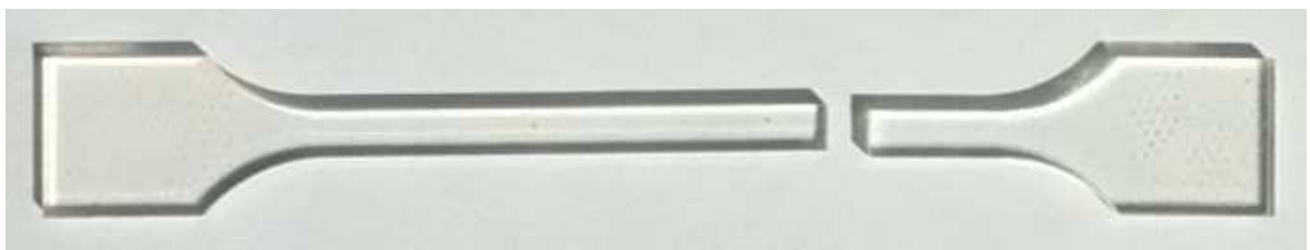
Obr. 31. Přetržení vzorku typ 1A zúžený na 6mm
