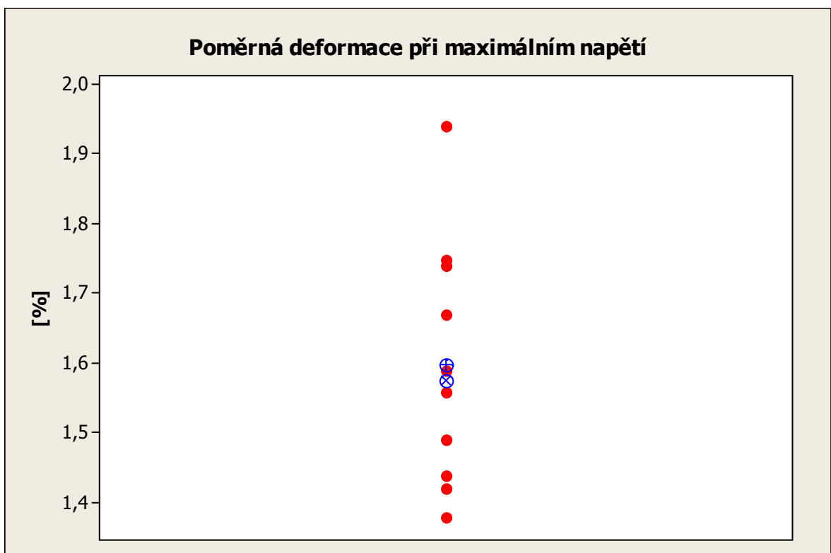
Obr. 33. Vyhodnocení poměrné deformace vzorek zúžený na 6mm
