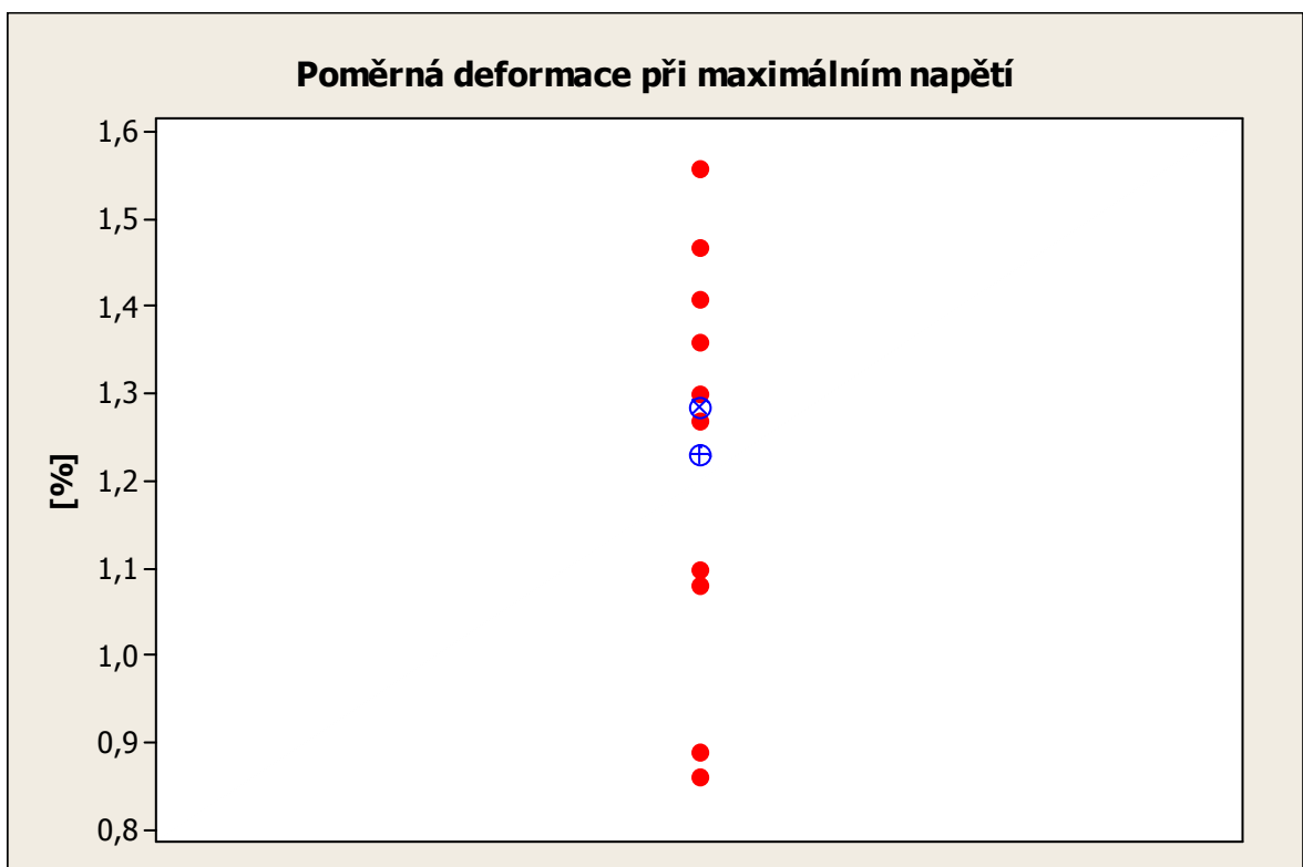
Obr. 25. Vyhodnocení poměrné deformace při maximálním napětí vzorek nezúžený
