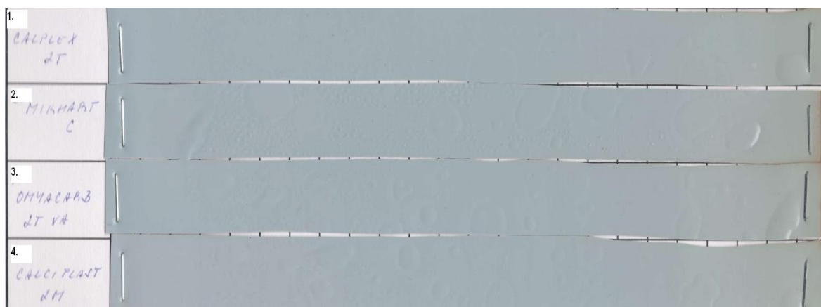
Obr. 25 : Stanovení tepelné stability při 180 °C, barva 211 (světle šedá)
