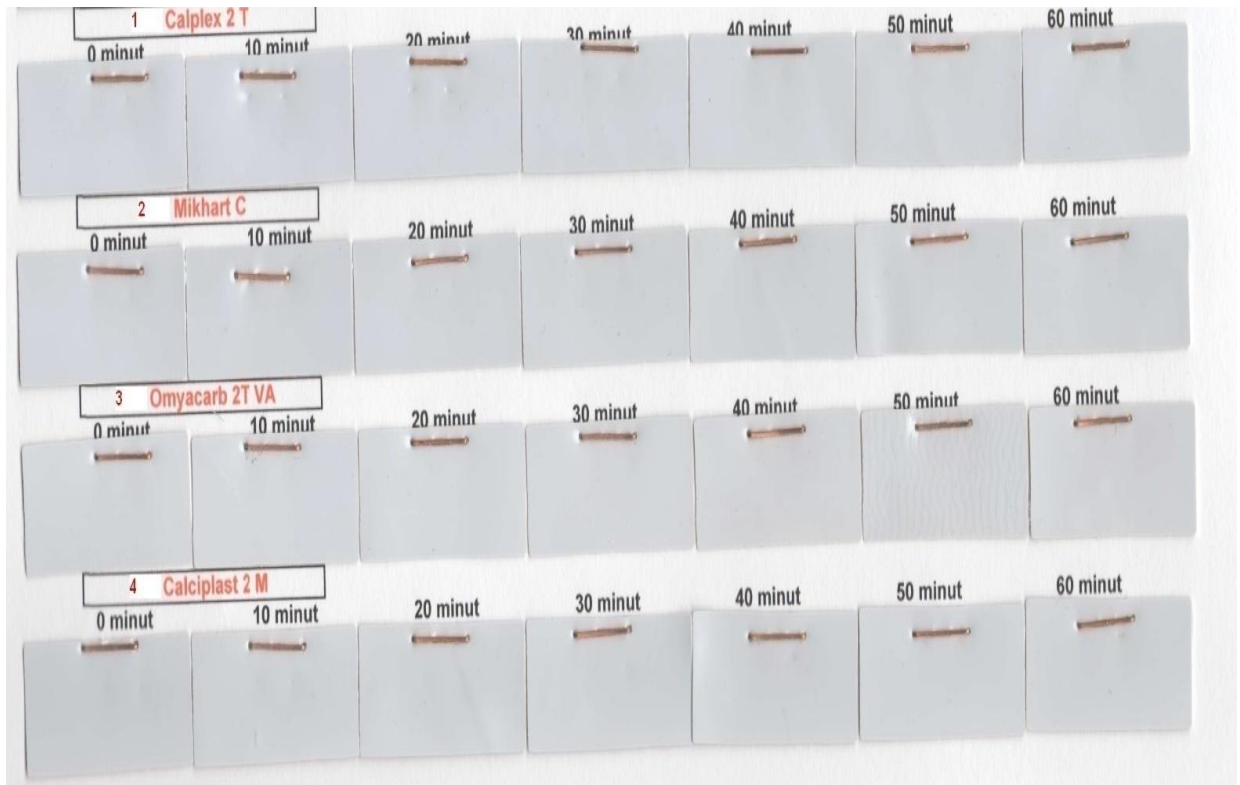
Obr. 29 : Dynamická tepelná stabilita při 170 °C, barva 201 (bílá)
