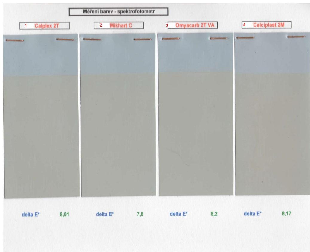
Obr. 27 : UV stabilita - expozice 500 hodin/zařízení QUV Tester, barva 211 (světle šedá)
