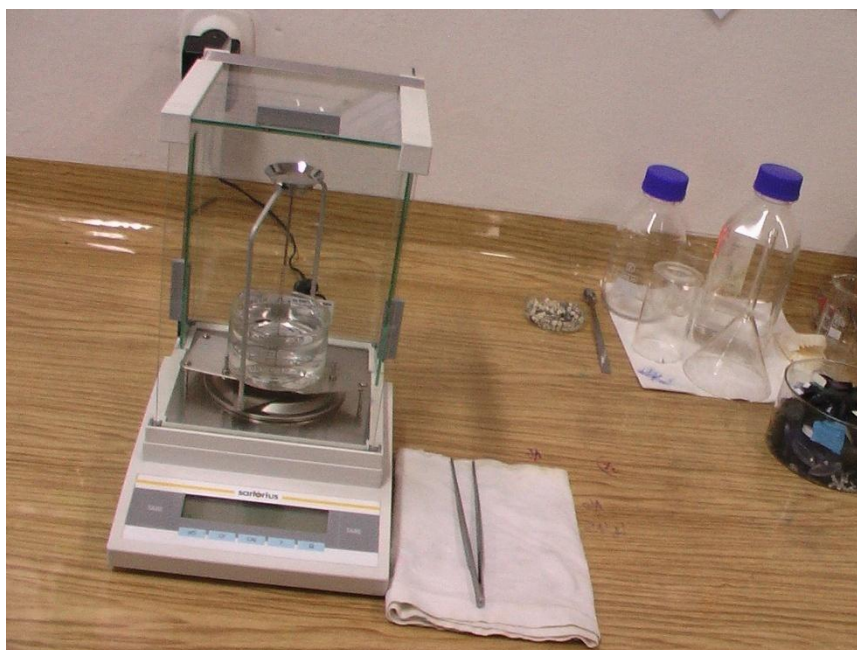
Obr. 17 : Analytické váhy Mettler + nádstavec YDK 01 pro měření hustoty
