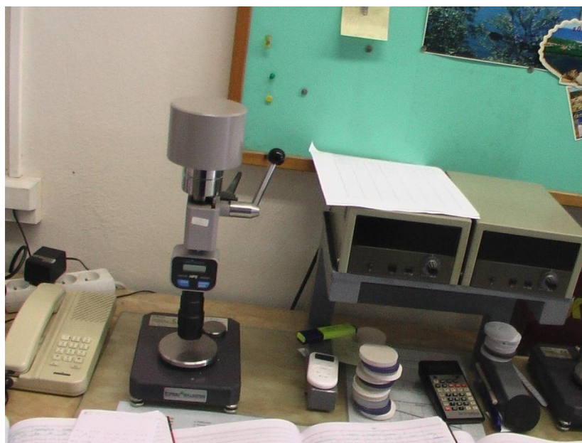
Obr. 16 : Digitální tvrdoměr k měření tvrdosti Sh D
