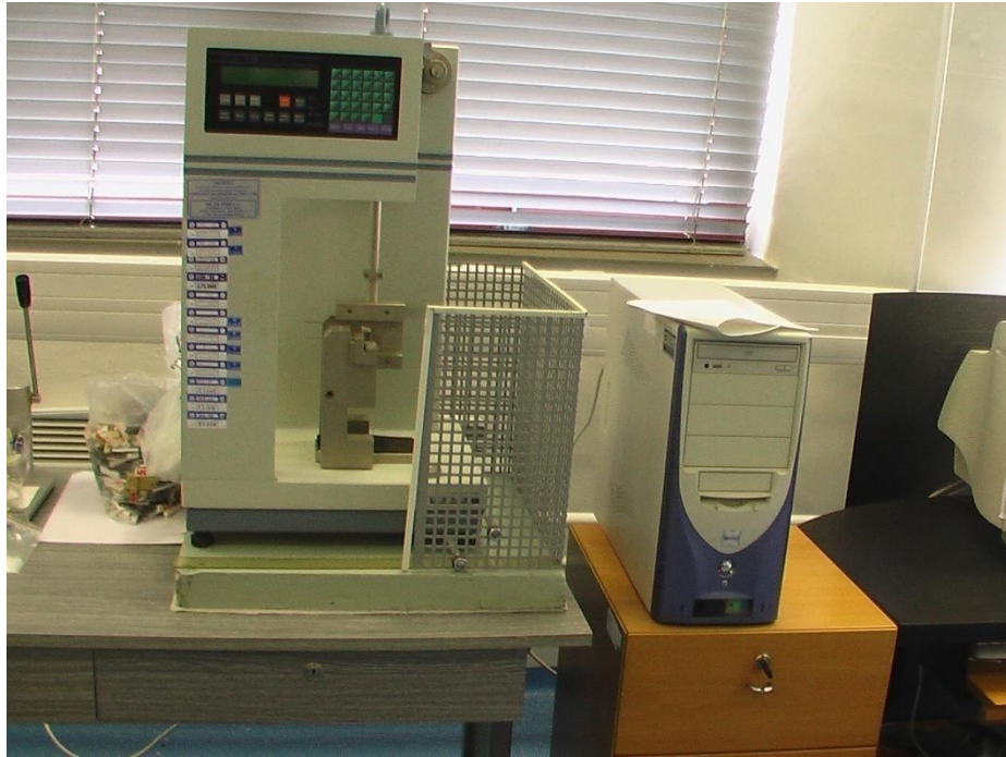
Obr. 20 : Přístroj k měření vrubové houževnatosti – rázové kladivo RESIL 5,5 CEAST
