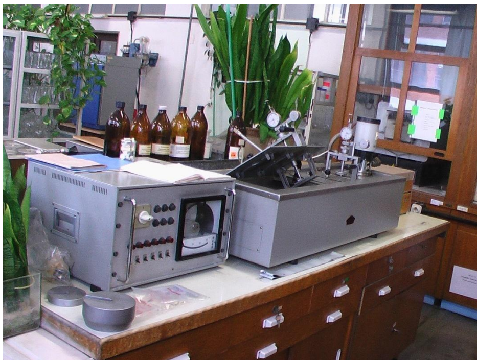
Obr. 19 : Zkušební zařízení FRANK k měření teploty měknutí dle Vicata
