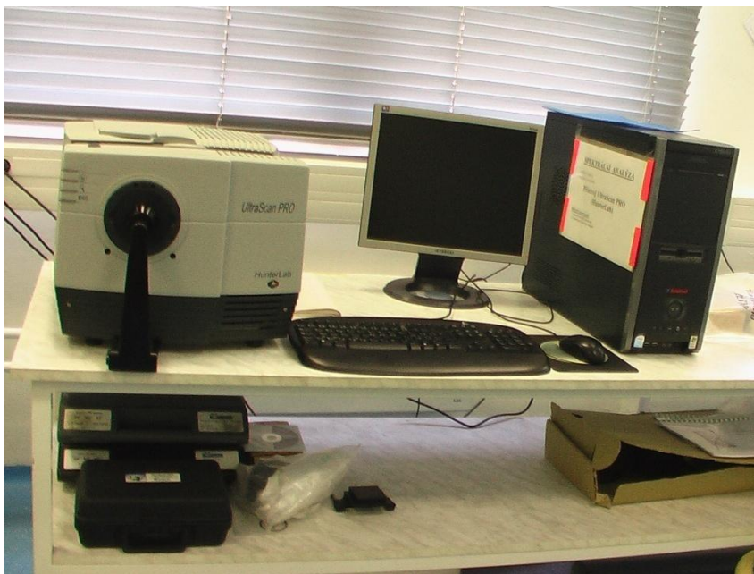
Obr. 22 : Laboratorní přístroj- spektrofotometr ULTRA SCAN PRO
