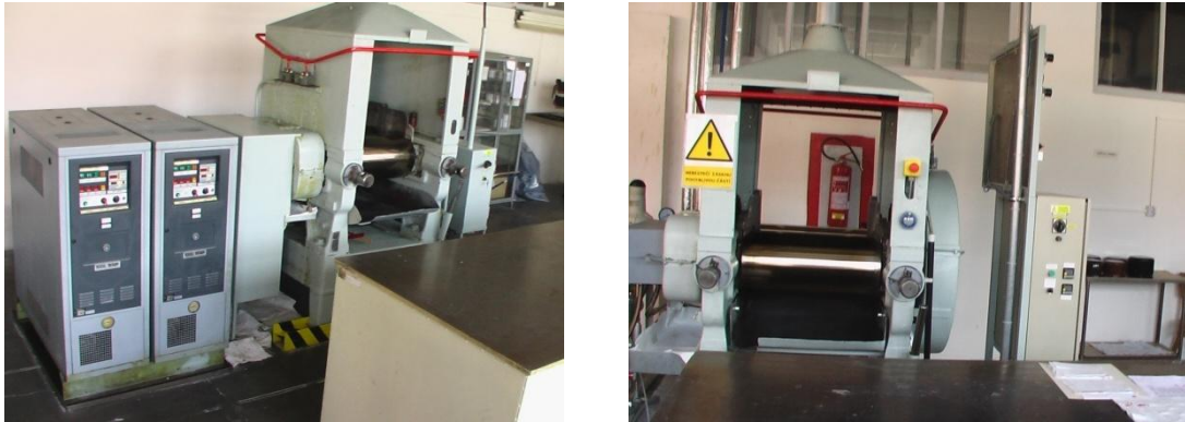
Obr. 15 : Laboratorní 2 – válcový kalandr
