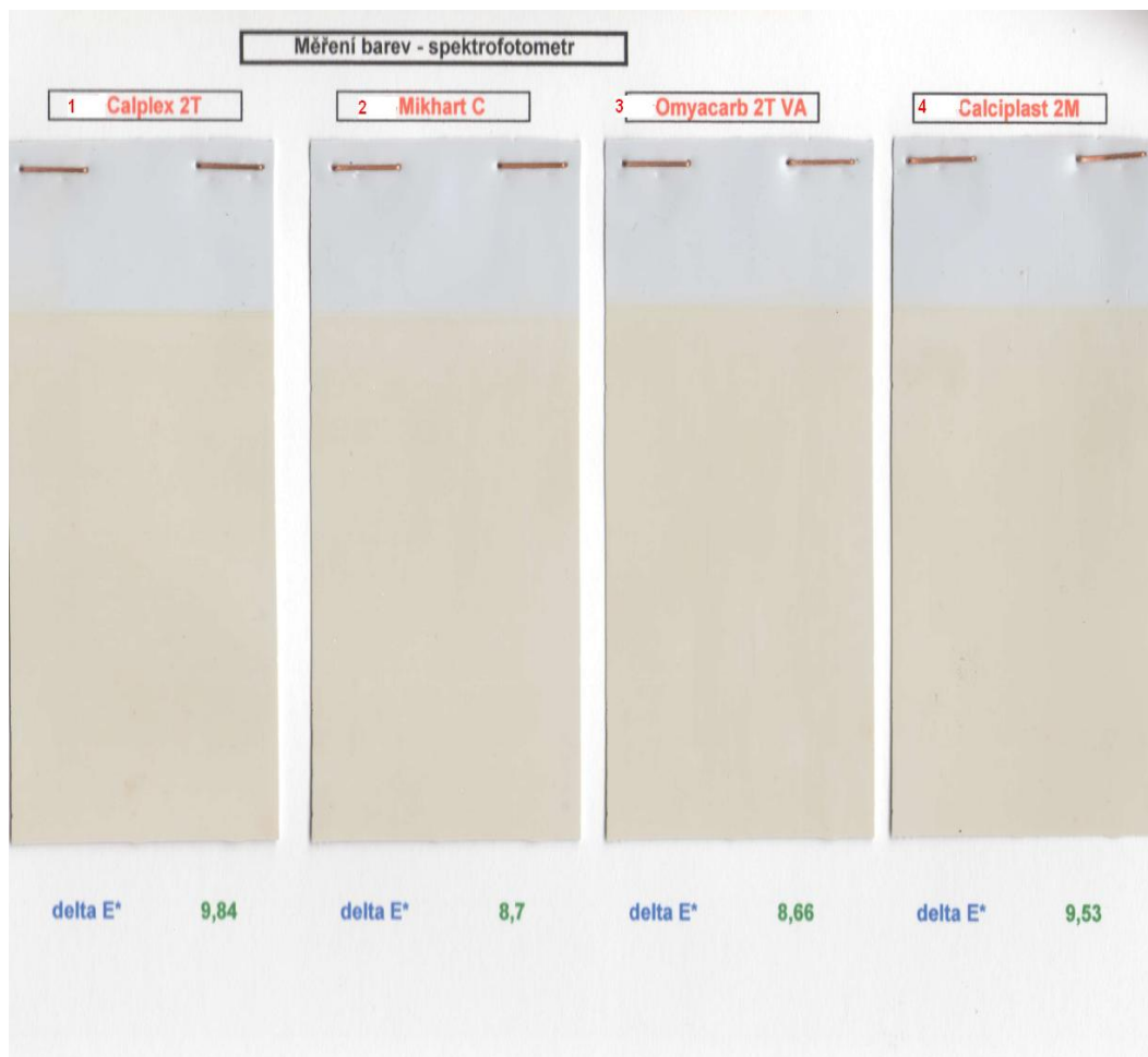
Obr. 30 : UV stabilita - expozice 500 hodin/zařízení QUV Tester, barva 201 (bílá)
