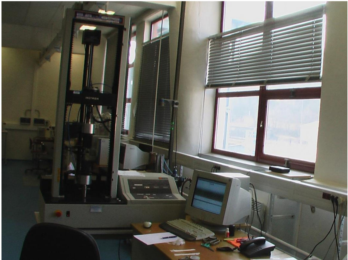
Obr. 18 : Přístroj pro tahové zkoušky – Instron 4301
