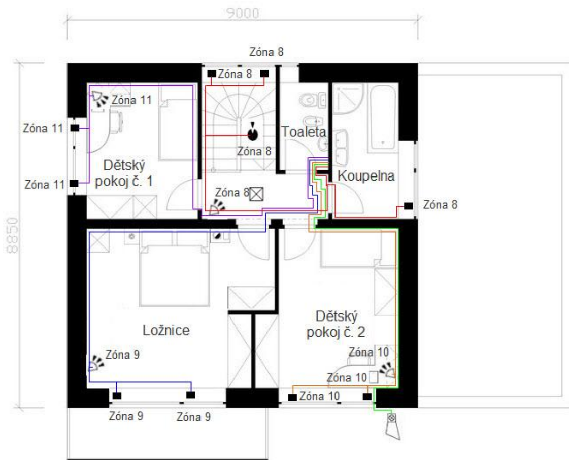
Obr. 28 Návrh zabezpečení objektu v 1. patře [39]
