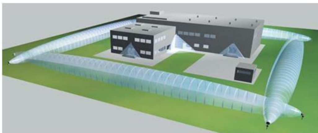
Obr. 12 Instalace MW bariér [35]
