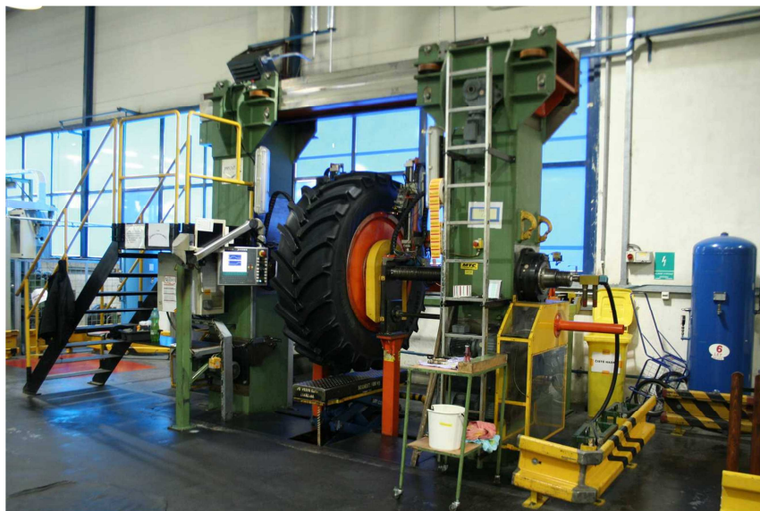
Obrázek 25. Stroj na měření uniformity pláště.
