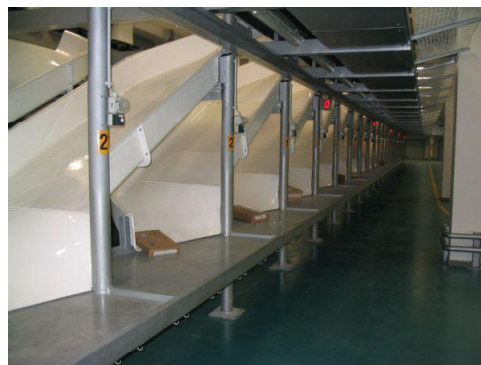
Obr. 8. Skluzy od balíkového třidiče.
