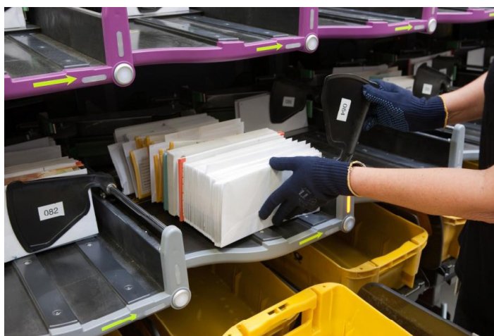
Obr. 14. Výstup třídícího listovního stroje, model IRV 3.000.
