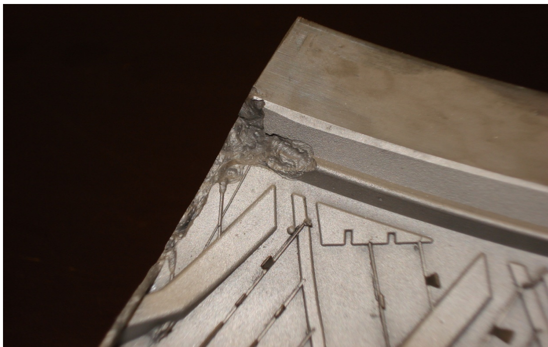
Obrázek 11 Chybějící materiál bočního pásku
