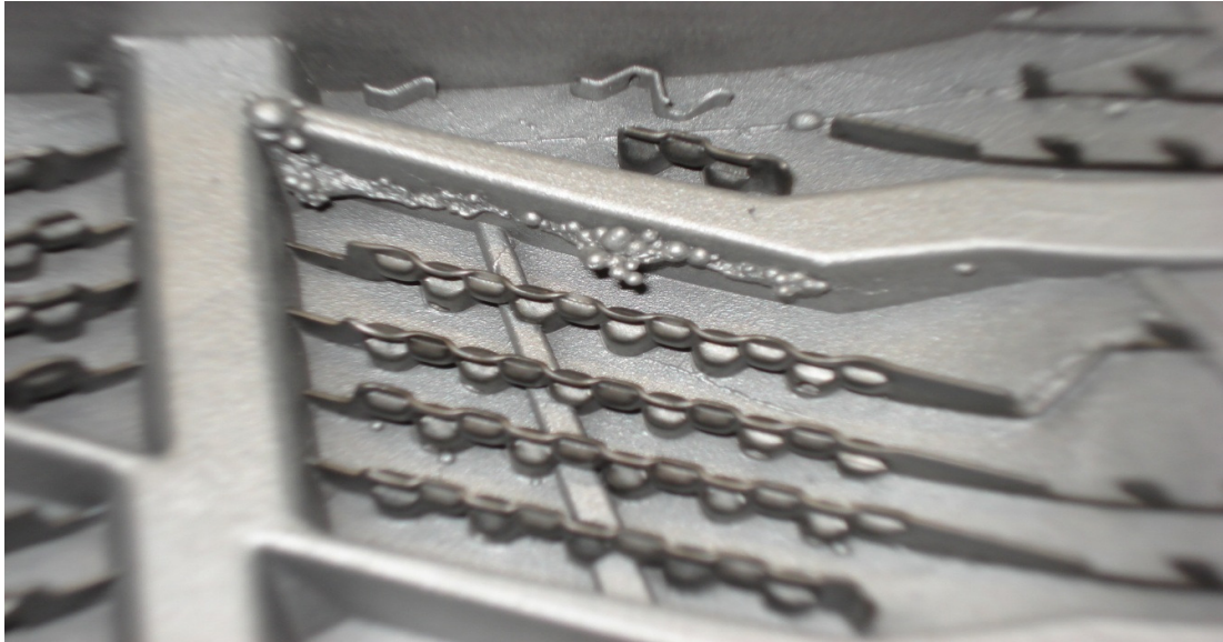
Obrázek 12 Vysoké výronky na žebrech
