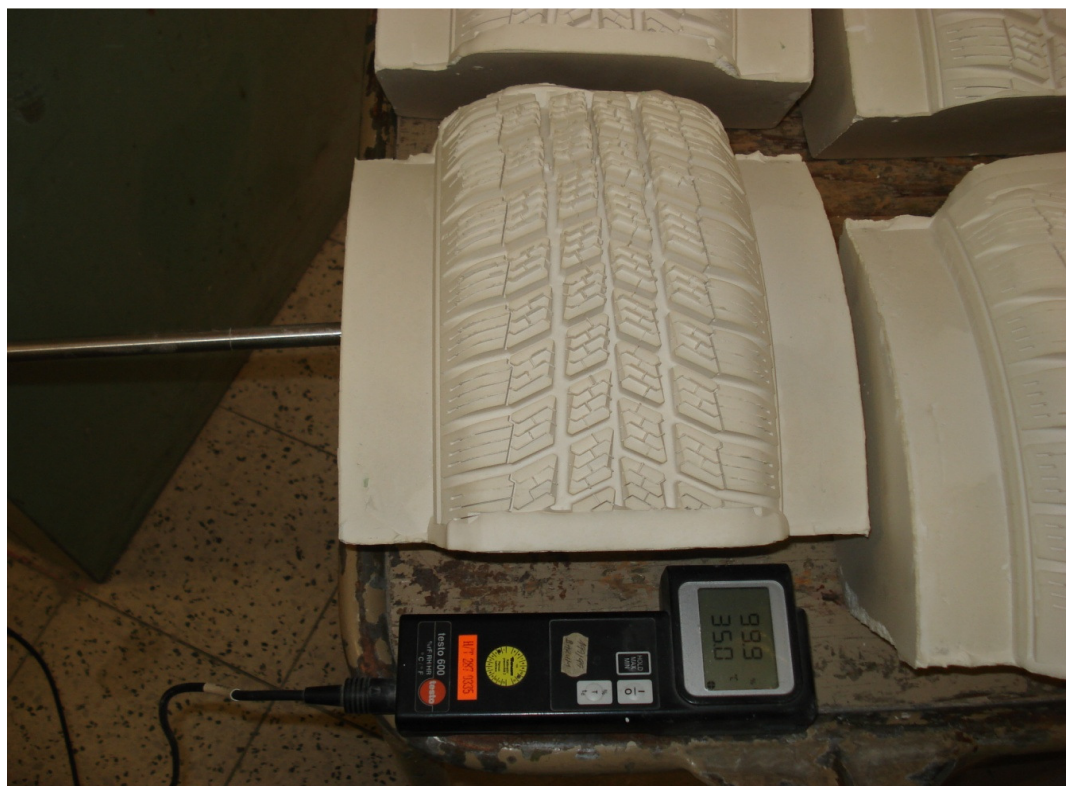
Obrázek 32 Měření vnitřní vlhkosti a teploty sádrového jádra
