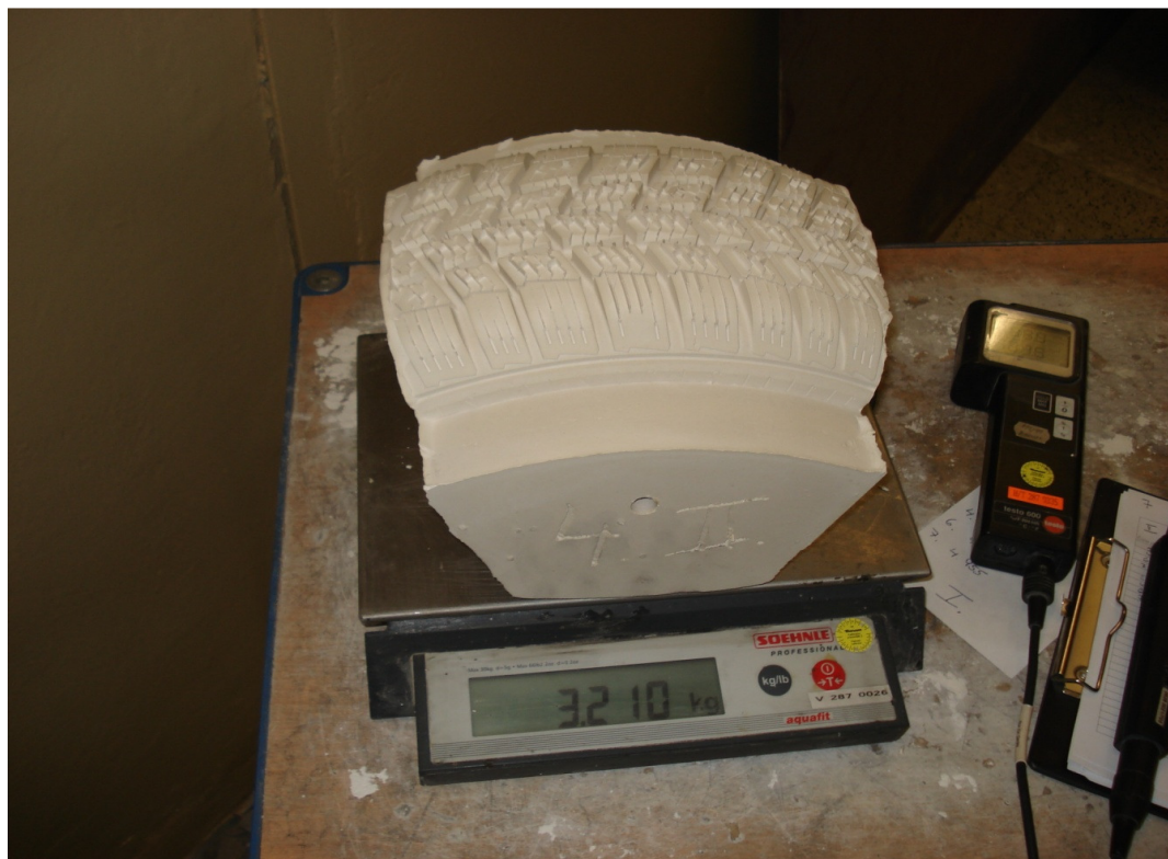
Obrázek 31 Měření hmotnosti sádrového jádra
