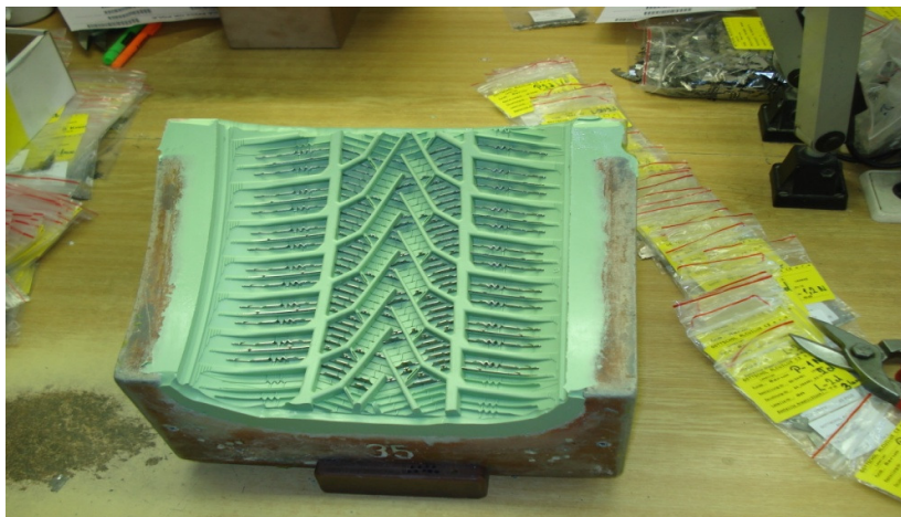
Obrázek 4 Flexibelová kopie modelu s částečně vloženými lamelami
