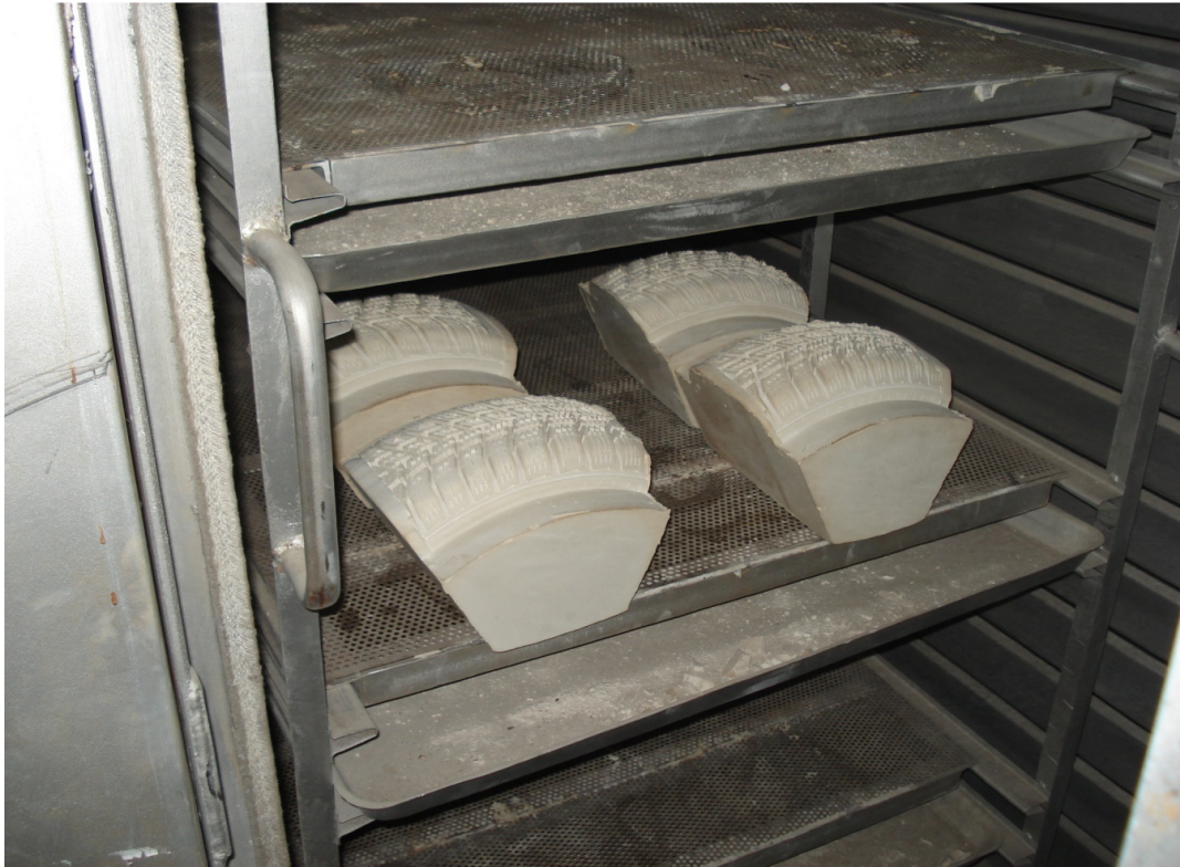
Obrázek 33 Umístění vsázky v sušárně
