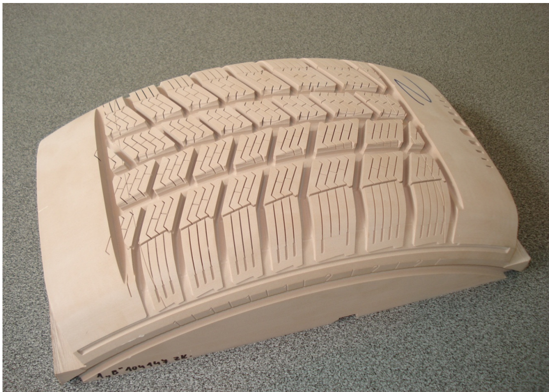
Obrázek 3 Model s umělého dřeva s vyfrézovaným dezénem
