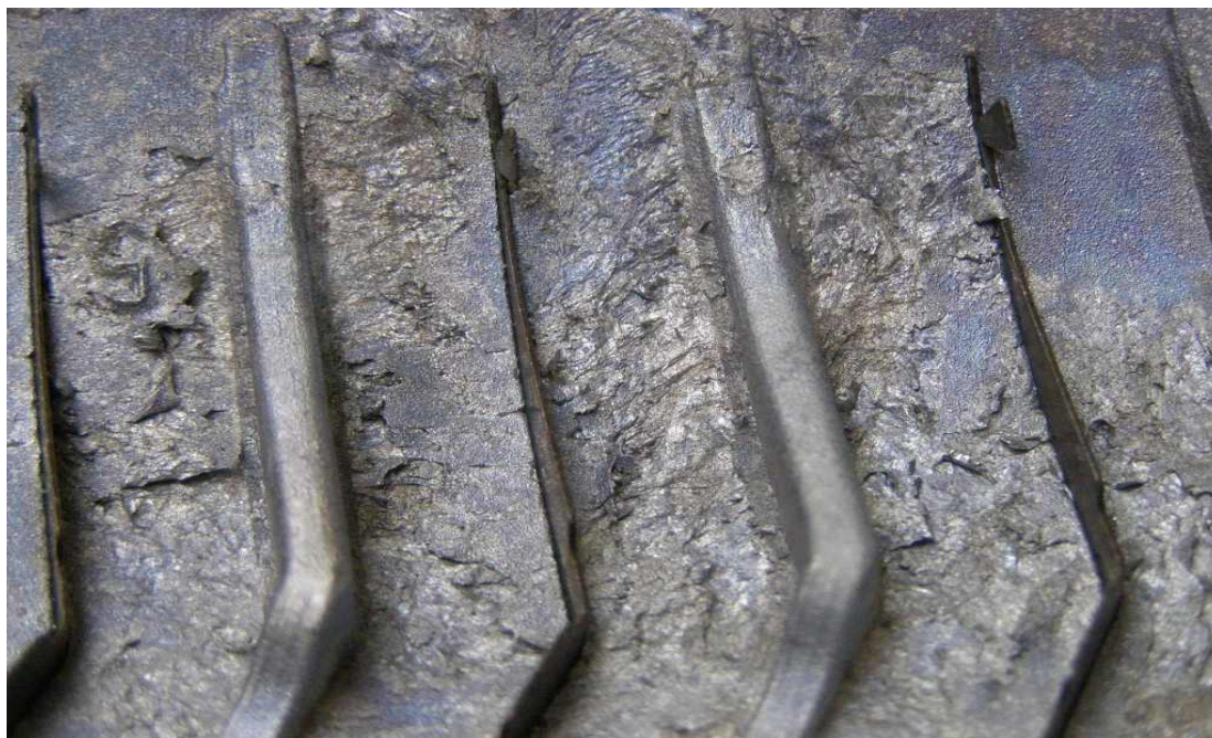
Obrázek 10 Řediny vzniklé nežádoucí chemickou reakcí
