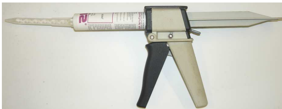
Obr. 20. Vytačovací pistole pro lepidlo Plexus MA310.
