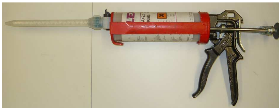
Obr. 21. Vytačovací pistole pro lepidla Plexus MA422 a MA832.
