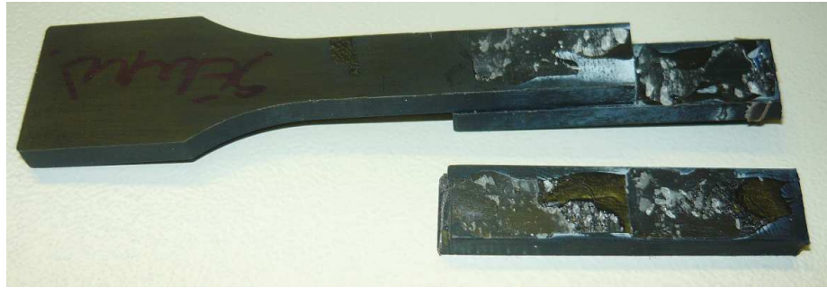
Obr. 27. Porušení spoje, u materiálu PA6 (plněný), lepeného sekundovým kyanoakrylátovým lepidlem.
