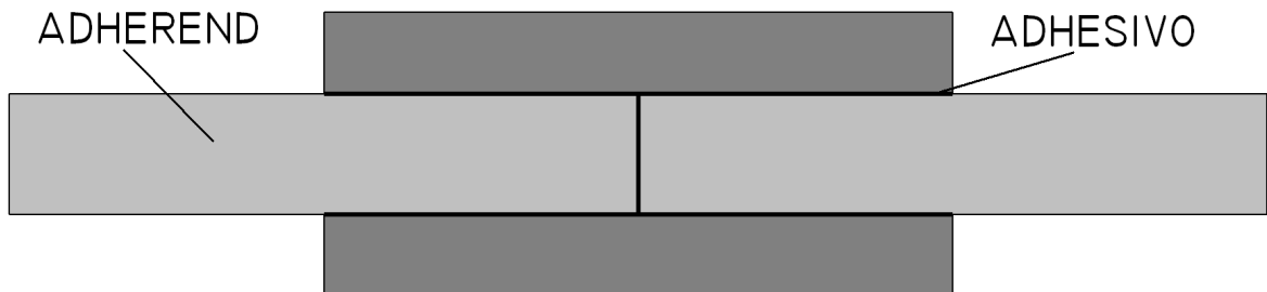
Obr. 22. Čelní spoj se dvěma příložkami.
