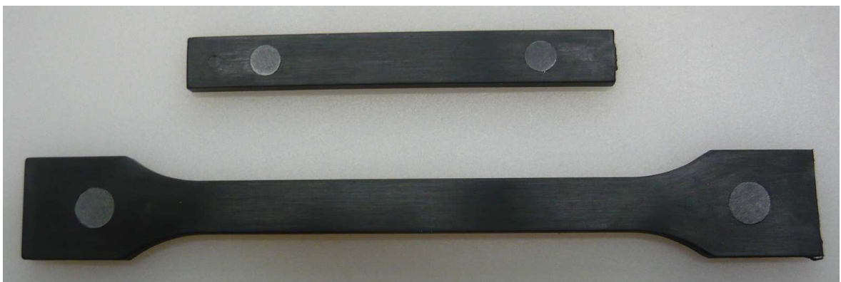
Obr. 16. Zkušební vzorek a pásek pro přeplátování.
