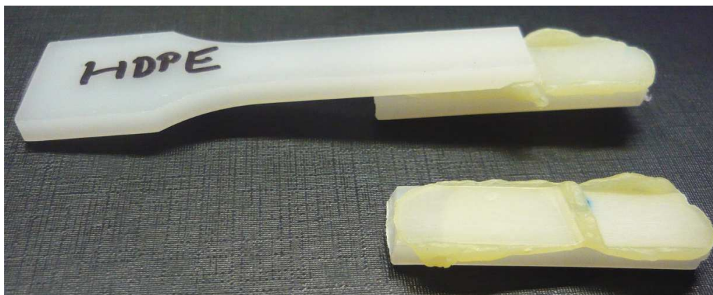
Obr. 48. Porušení spoje, u materiálu HDPE, lepeného lepidlem Plexus MA310.
