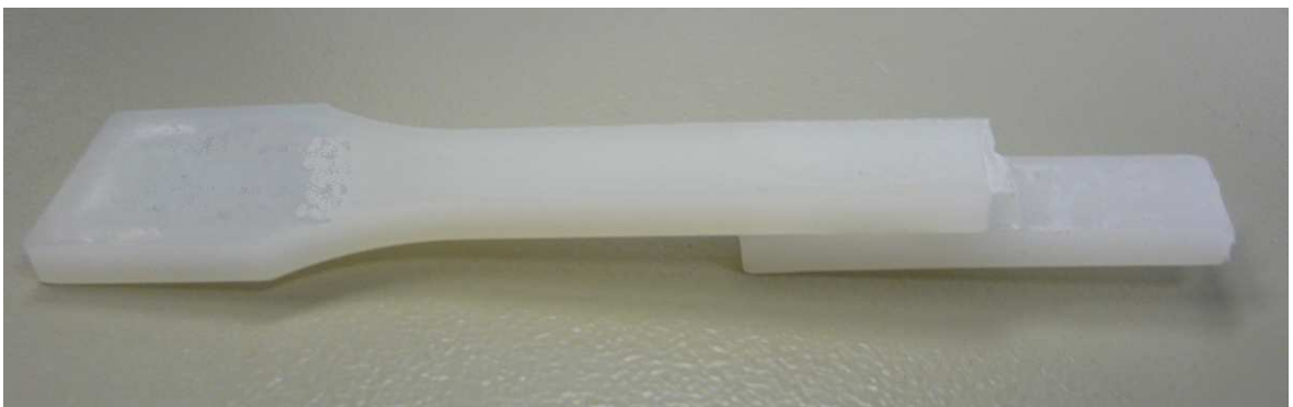
Obr. 46. Porušení spoje, u materiálu HDPE, lepeného sekundovým lepidlem.
