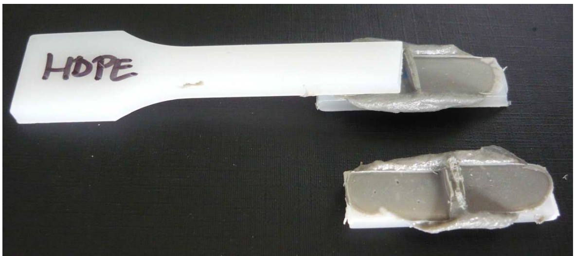
Obr. 52. Porušení spoje, u materiálu HDPE, lepeného lepidlem Plexus MA832.
