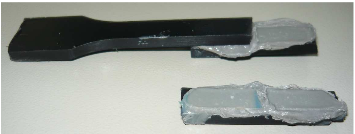
Obr. 36. Porušení spoje, u materiálu PA6 (plněný), lepeného lepidlem Plexus MA832.
