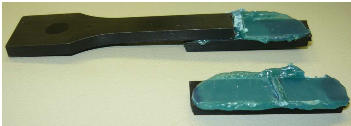
Obr. 33. Porušení spoje, u materiálu PA6 (plněný), lepeného lepidlem Plexus MA422.
