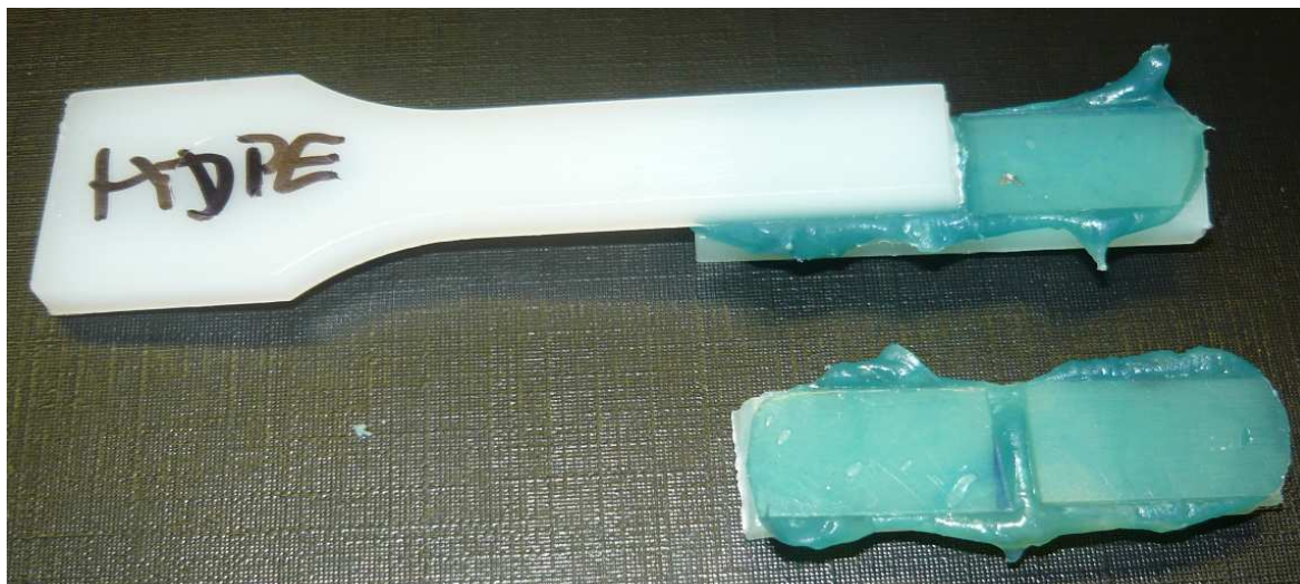
Obr. 50. Porušení spoje, u materiálu HDPE, lepeného lepidlem Plexus MA422.
