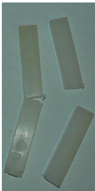
Obr. 91: Lom zkušebních tělísek naložených ve FAM-B.
