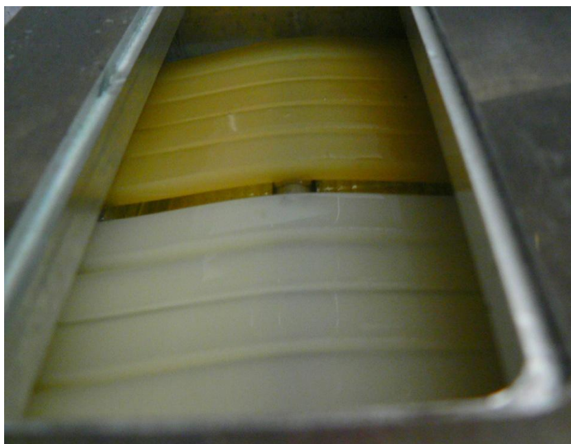
Obr. 128: Umístněný tělísek v prostředí brzdové kapaliny. (vpravo zesíťované PA12, vlevo nezesíťované PA12)
