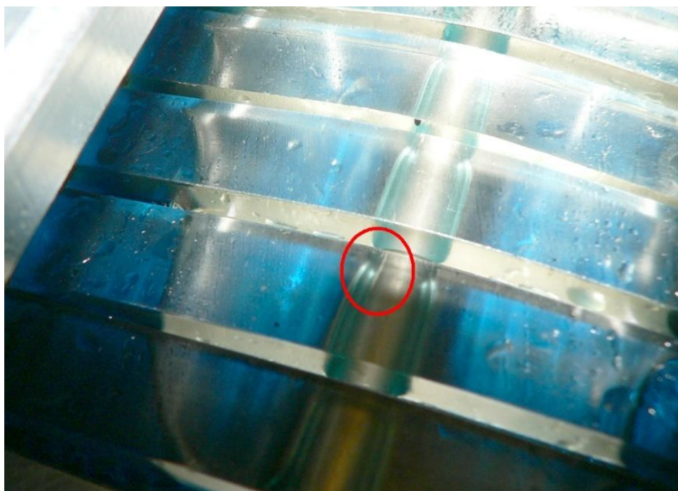
Obr. 125: Stav tělísek zesíťovaného PA11 v etylenglykolu po 72 hodinách.
