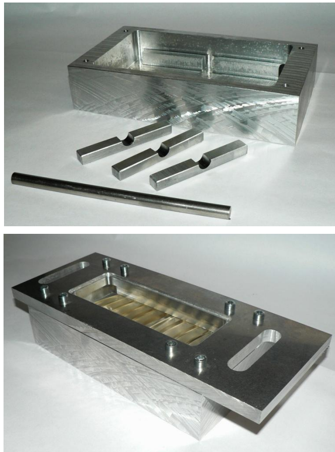
Obr. 36: Přípravek pro zkoušení ESC.
