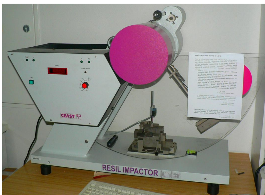
Obr. 34: Zkušební přístroj Resil Impactor Junior.
