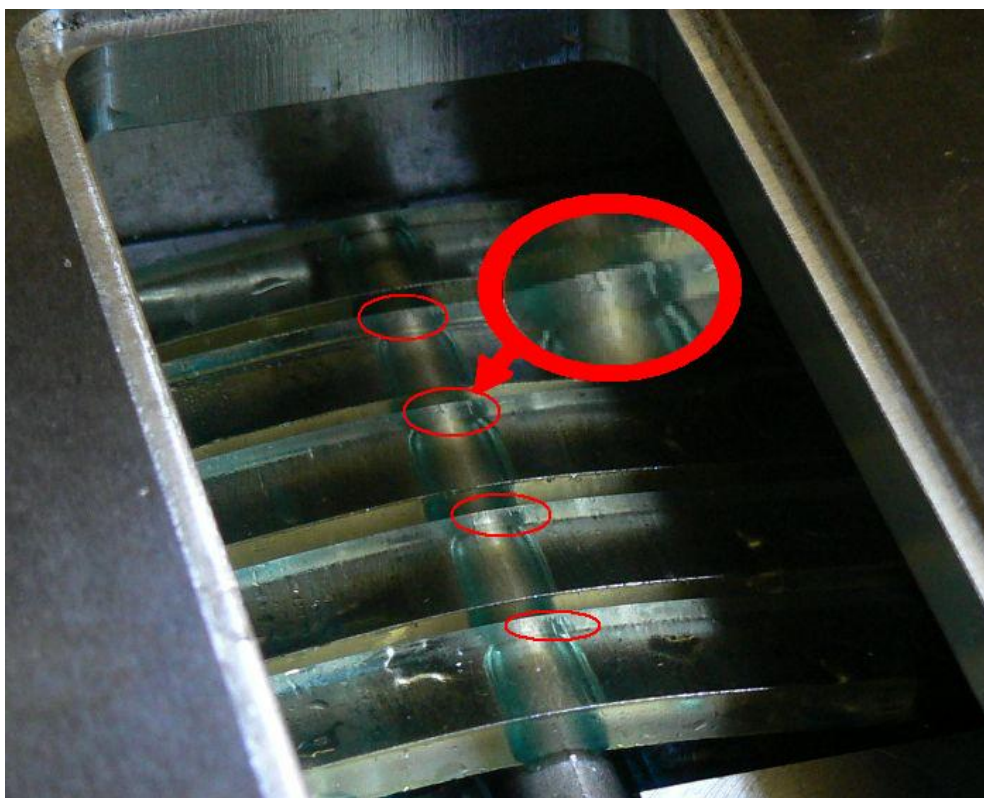
Obr. 123: Stav tělísek zesíťovaného PA11 v etylenglykolu po 24 hodinách.
