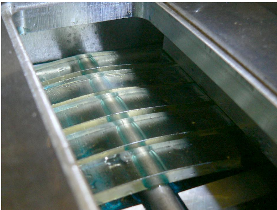
Obr. 122: Stav tělísek nezesíťovaného PA11 v etylenglykolu po 24 hodinách.
