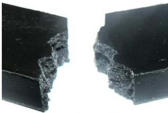
Obr. 114: Lom zkušebního tělíska PA66 30% GF.
