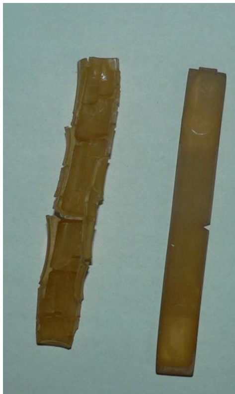
Obr. 78: Lom zkušebních tělísek naložených ve FAM-B.
