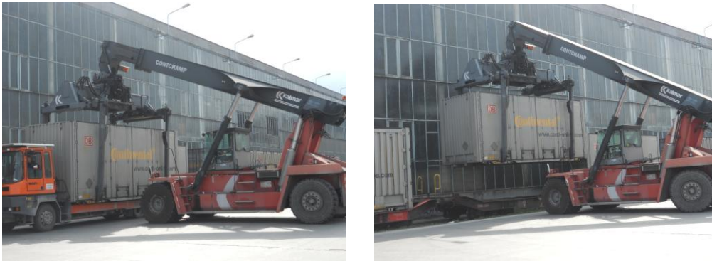
Obr. 14. Nakládka megaboxu pomocou výsuvného čelného prekladača
