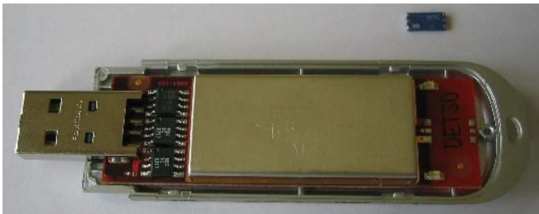
Obrázek 32. MSI-6967 po odstranění SMT antény
