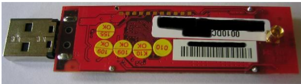
Obrázek 33. MSI-6967 po připojení konektoru externí antény
