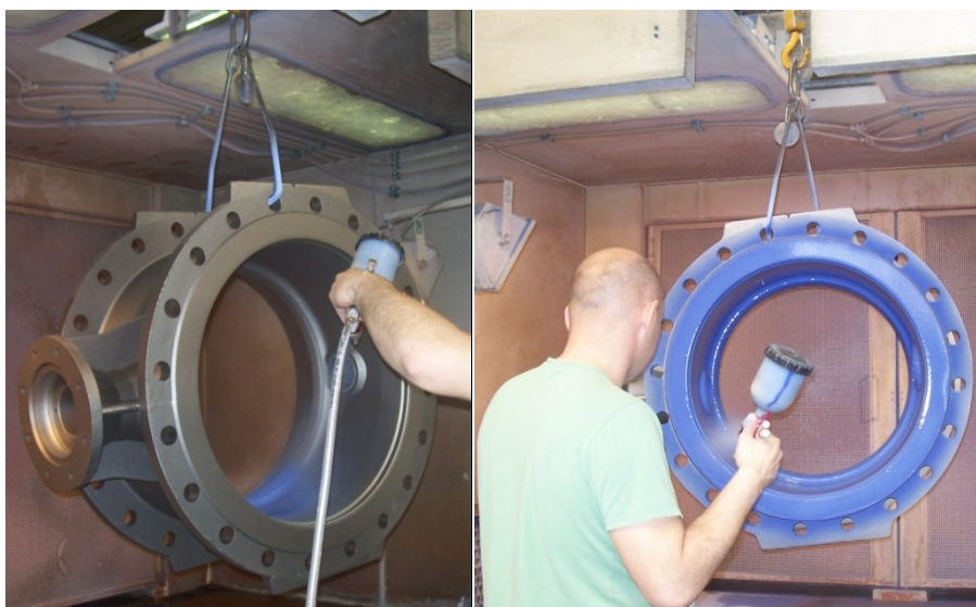
Obr. 24. Nástřik smaltu na těleso EKN uzavírací klapky DN 600
