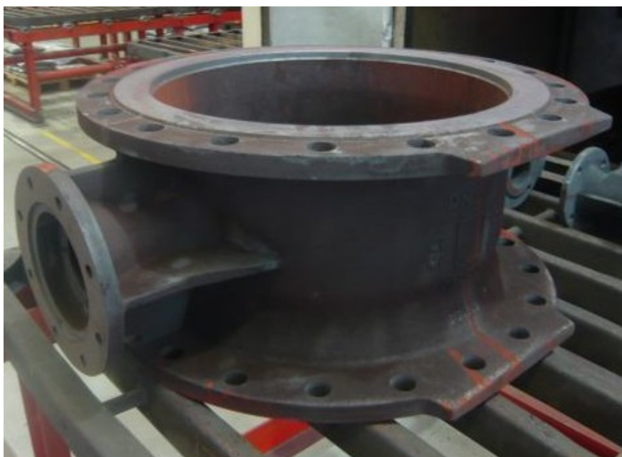
Obr. 15. Těleso EKN uzavírací klapka DN600 po žihání.
