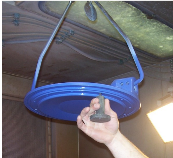
Obr. 23. Montáž podpěr na čerstvě smaltované těleso, aby se při pokládání tělesa zabránilo poškození nástřiku smaltu
