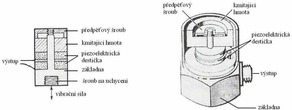
Obr. 17. Konstrukce piezoelektrického akcelerometru
