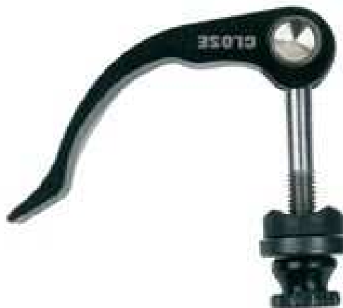
Obr. 15. Pákový rychloupínač s výstředníkovým uložením.
