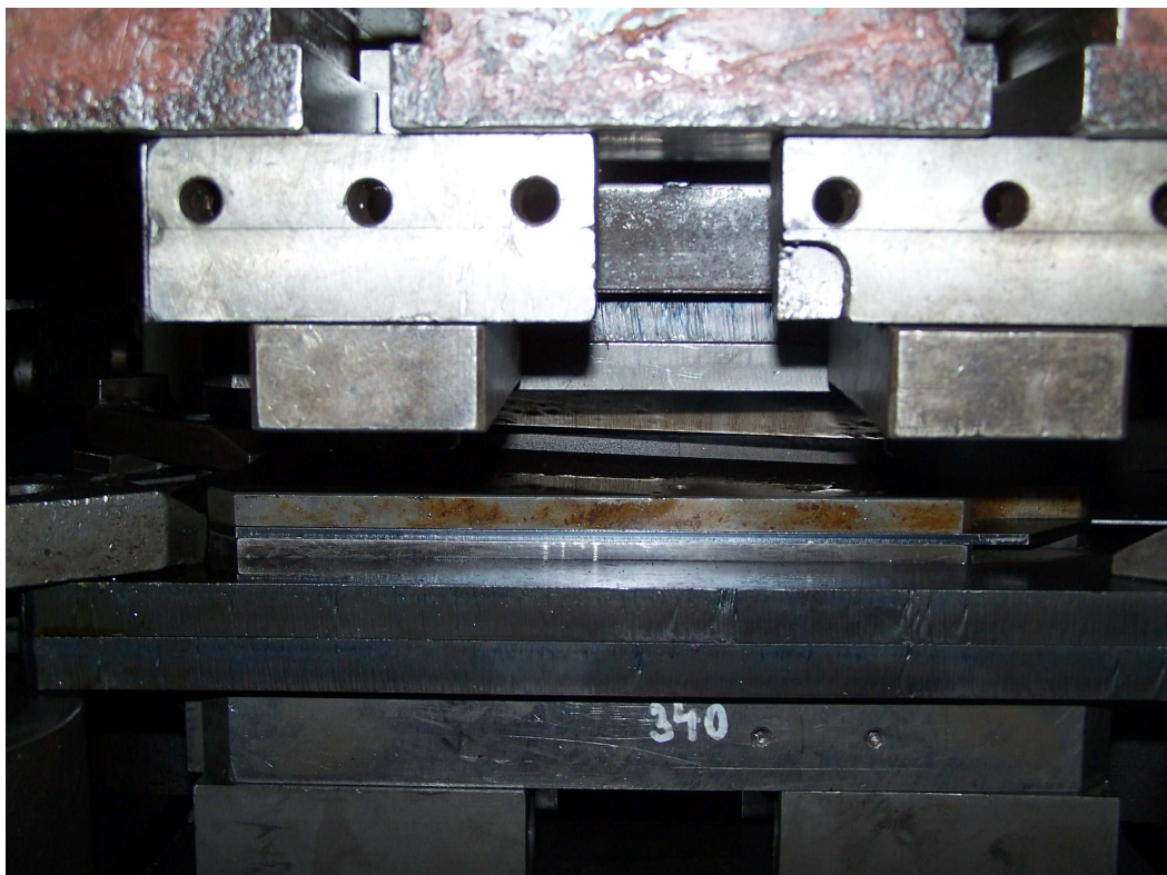
Obr. 47 1- účelový prípravok na strihanie kónusu na lise Šmeral LDC 160
