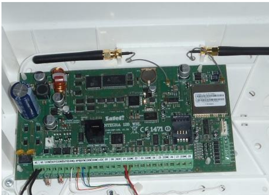
Obr. 24: Vizuální kontrola zapojení ústředny
