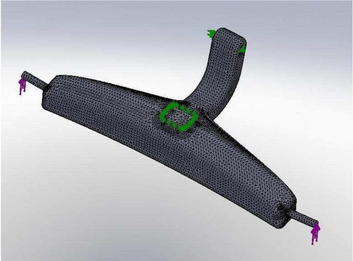
Obr. 23. Vysíťování upravené nosné části pro výpočet napětí a posunutí.
