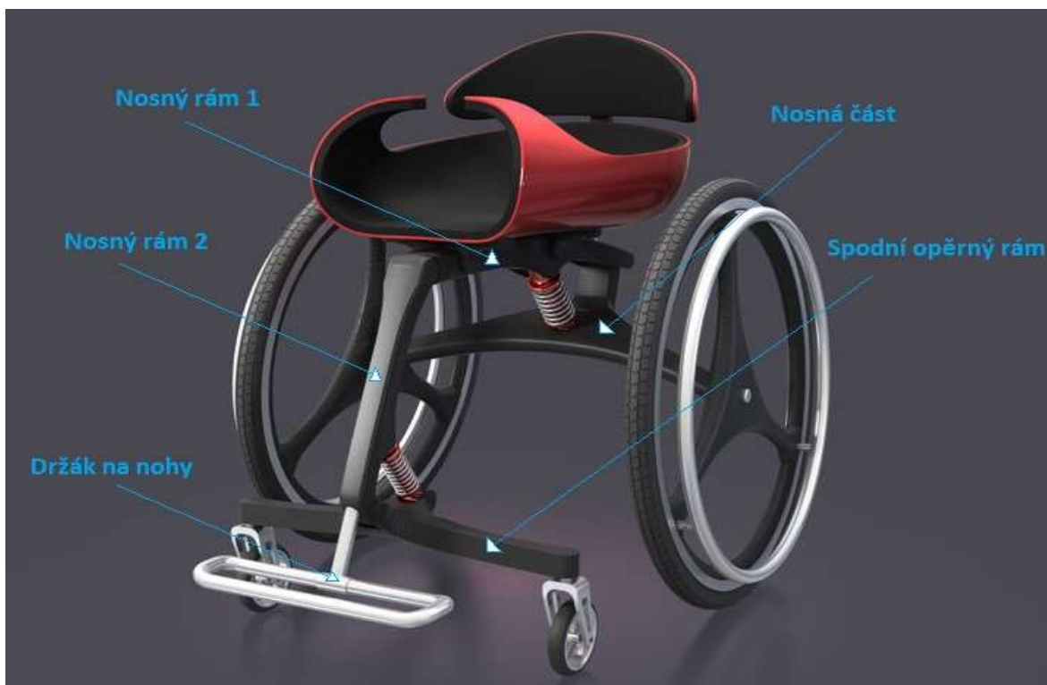
Obr. 9. Ukázka invalidního vozíku trilobit v zákl. provedení s popisem částí. [9]
