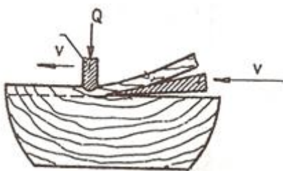
Obr. 27 Krájení dýhy nožem [15]
