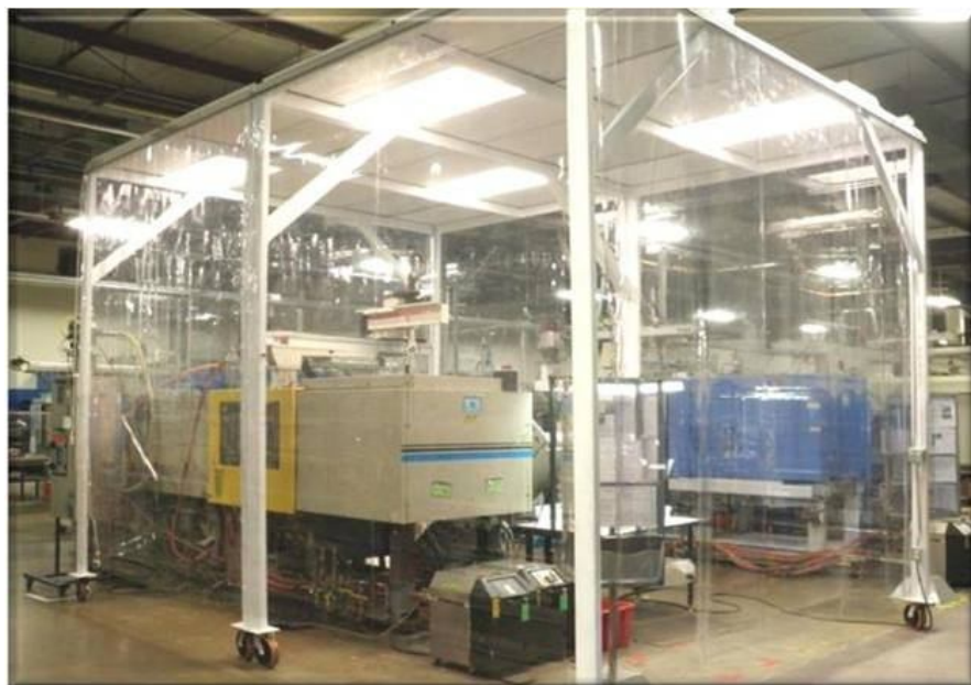
Obr. 14. Vstřikovací stroj v normálním prostředí splňující třídu čistoty ISO 9 [18]
