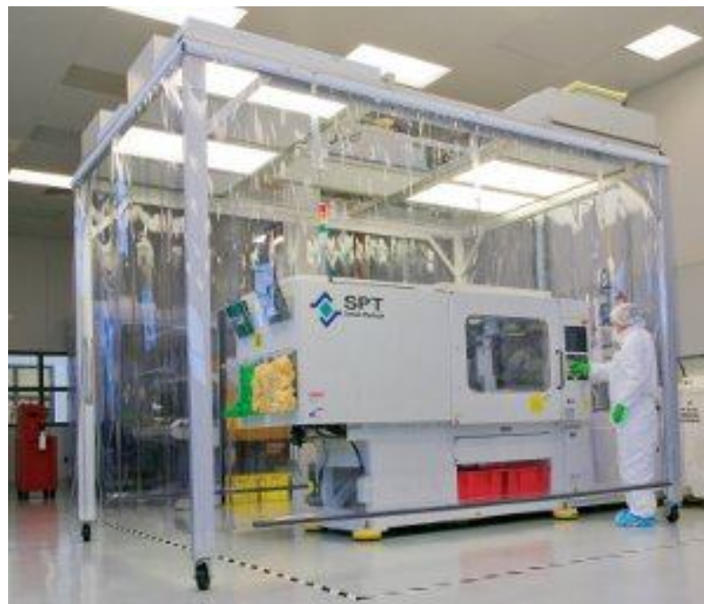
Obr. 21 Zvýšení třídy čistoty výroby z ISO 8 na ISO 7 [20]
