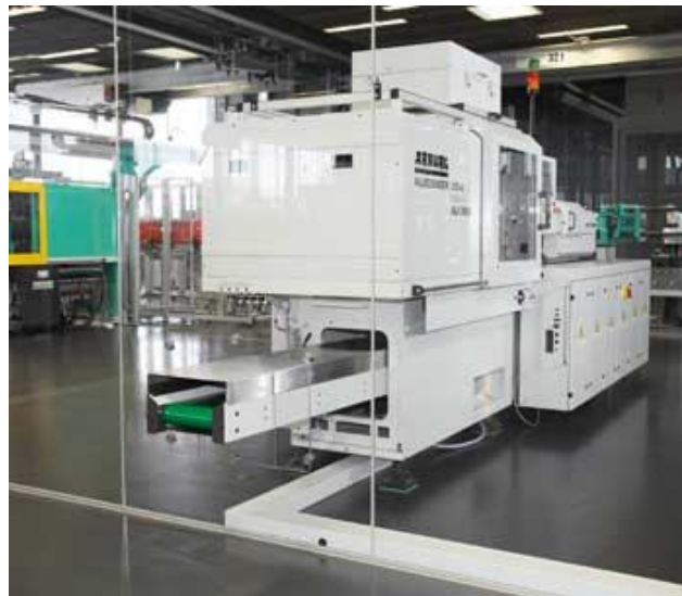
Obr. 13. Vstřikovací stroj Arburg 370A upravený pro cleanroom [17]
