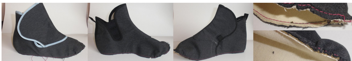
Obr. 50: Svršky s našitou stélkou - patrné zvrásnění v důsledku chyby v šablonách.
