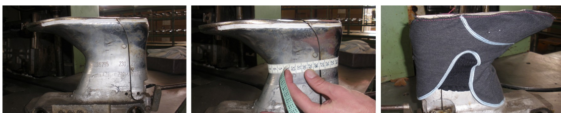
Obr. 49: Kovová nožka - měření obvodu, zkouška svršku.
