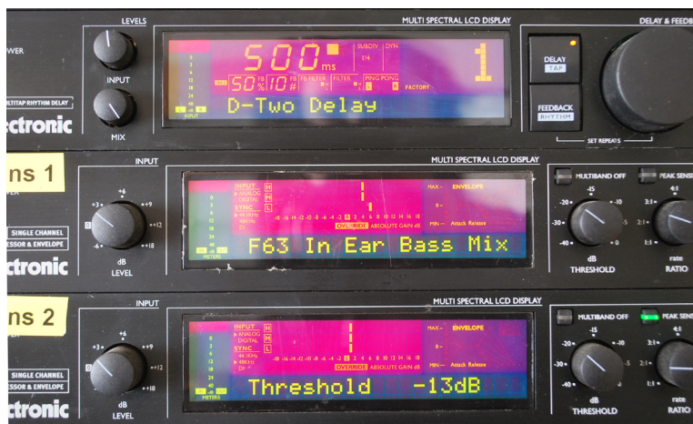
Ukázka externích digitálních kompresorů TC Electronics s možností přepnutí režimu jednopásmový nebo vícepásmový.
