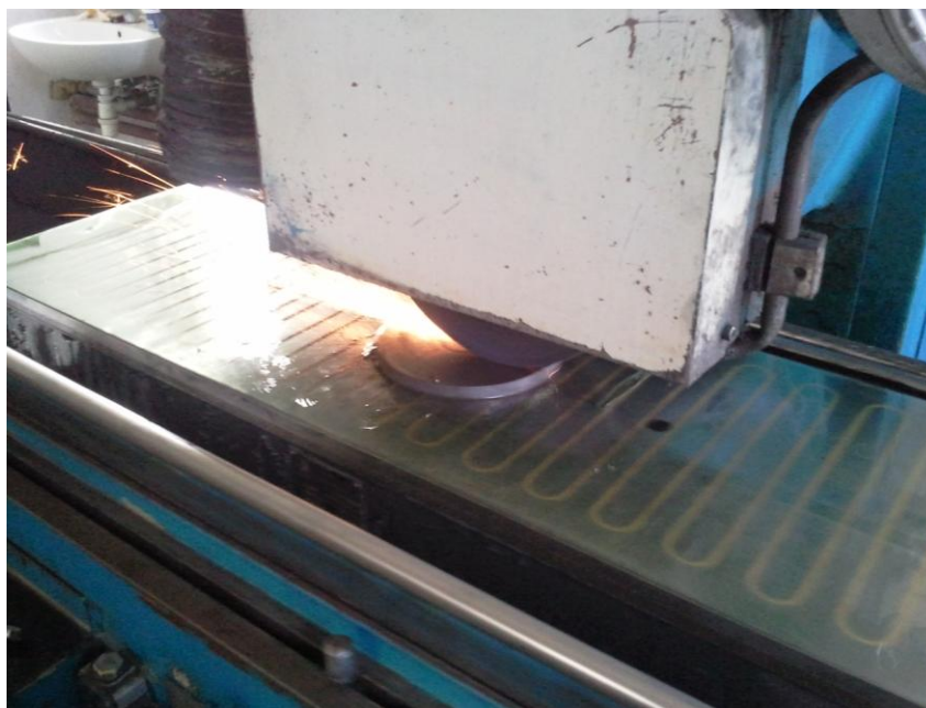
Obr. 27. Broušení zkoušeného materiálu
