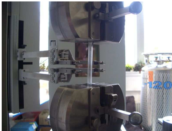
Obr. 29. Uchopení v čelistech při tahové zkoušce.
