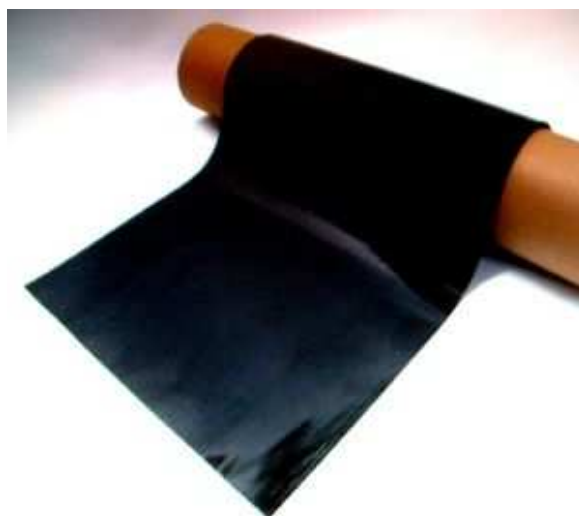
Obr. 6. Prepreg z uhlíkových vláken. [9]
