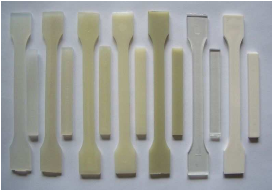
Obr. 28. Ukázka zkušebních těles. Zleva: PP neplněný, PP+15%GF, PP+30%GF, PA neplněný, PP+30%GF, PC, PS.
