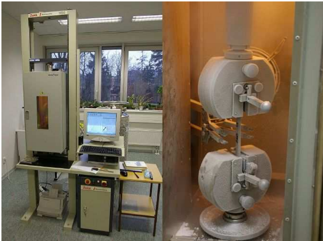
Obr. 27. Univerzální zkušební stroj s teplotní komorou. [28]
