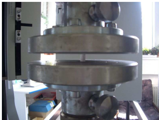
Obr. 30. Zkouška tlakem – měření meze pevnosti v tlaku.
