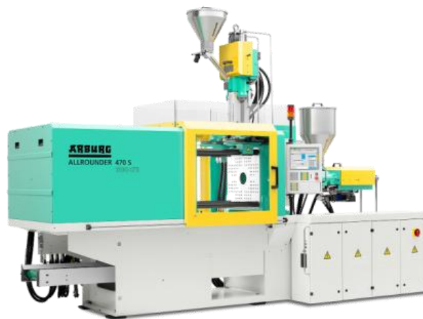
Obr. 10 Dvoukomponentní vstřikování, vstřik. jednotky ve tvaru písmena "V" [17]
