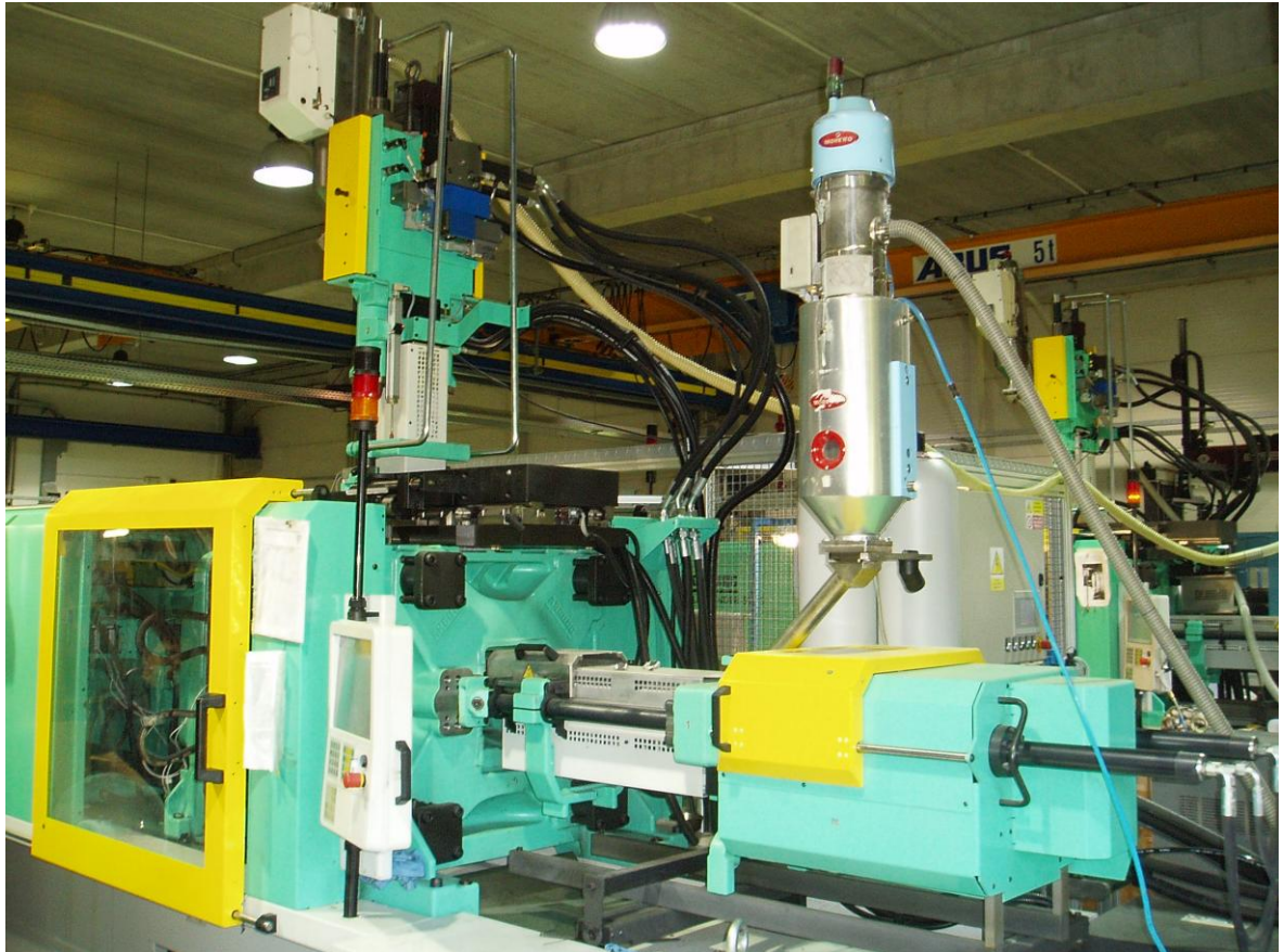
Obr. 21 Vstřikovací stroj Arburg 570 S 2200 – 400/170 pro 2K vstřikování [24]
