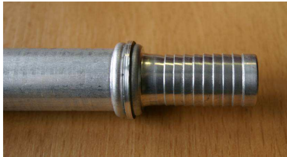
Obr. 4 Crimp – válcování drážek [16]
