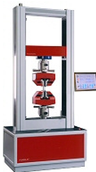
Obr. 27 Dvousloupový čelistový trhací stroj TIRA FS300 [38]
