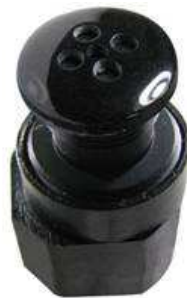
Obrázek 7 Mikrokamera maskovaná v knoflíku [9]
