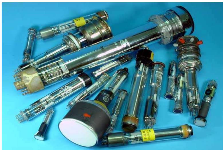
Obrázek 2 Snímací elektronky televizních kamer z kolekce Siegfried [17]
