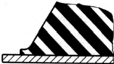
Obr. č. 28 - Správně - okrajová vlákna jsou odlehčena [7]
