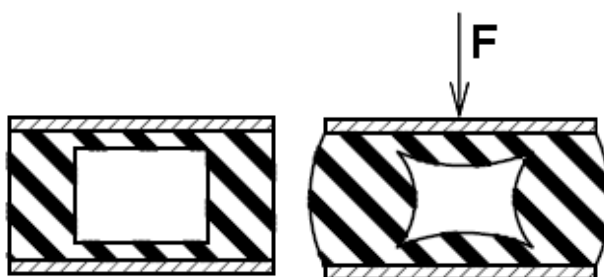
Obr. č. 35 - Špatně - v ostrých koutech při deformaci pružiny dochází ke koncentraci napětí
